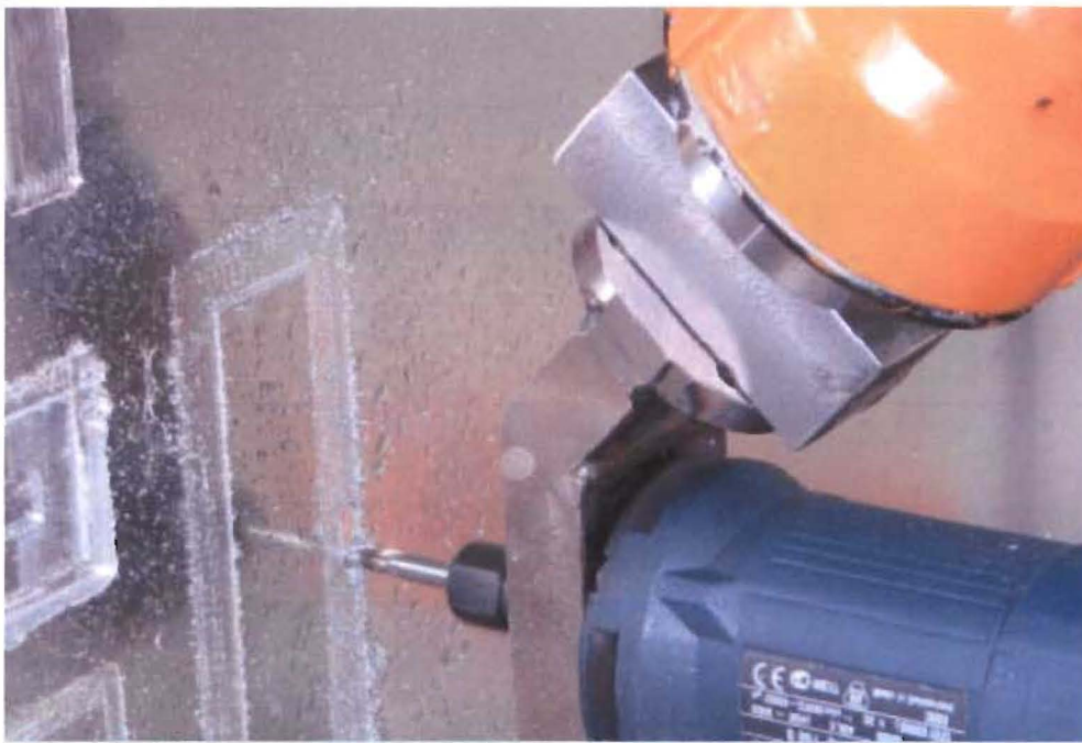
Bild: Fräsversuche mit dem Roboter an der FH in Bocholt
