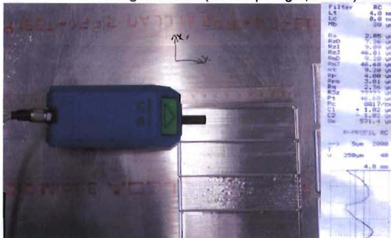
Bild: Rauheit entlang Y-Achse (Vorschub 6000 mm/min) ermittelter Ra Wert = 2,05\ \mu\text{m} Dickemessung mittels Ultraschall:
