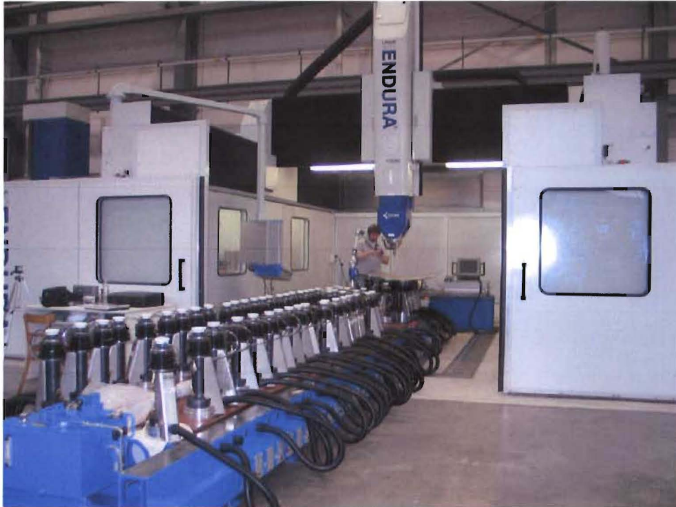
Versuchsanordnung Endura900 + modifizierte Spannvorrichtung A400 M Landeklappen
