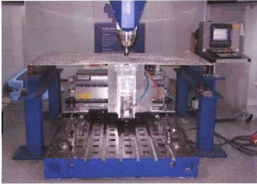
Bild: Dreiachsige Unterkonstruktion mit CNC-Steuerung (rechts)
