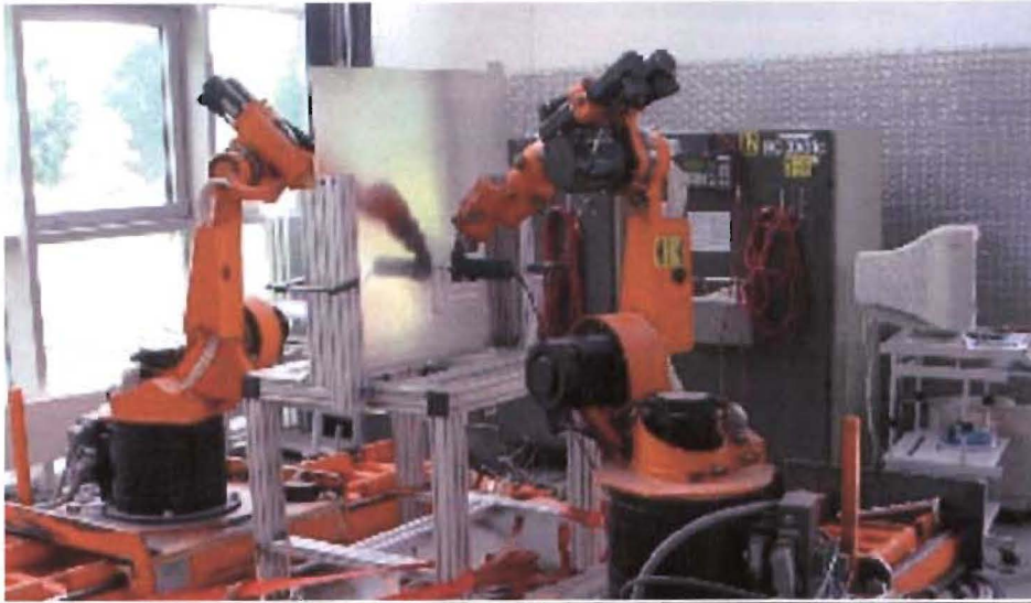
Bild: Prototypenanlage mit zwei Robotern zum Fräsen
