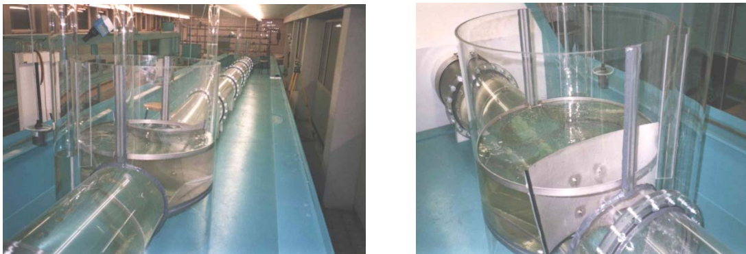
Abbildung 5: HydrOstyx-Abflussbremsen im Versuchskanal
