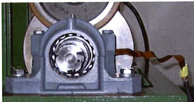
Abbildung 6: "Intelligentes Wälzlager" (oben), eingebaut (unten)
