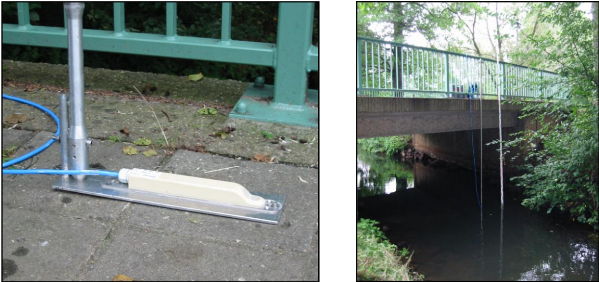
Abbildung 3-12: Gerät zur Durchflussmessung (links) und Einsatzort an der Brücke Ringchausee
