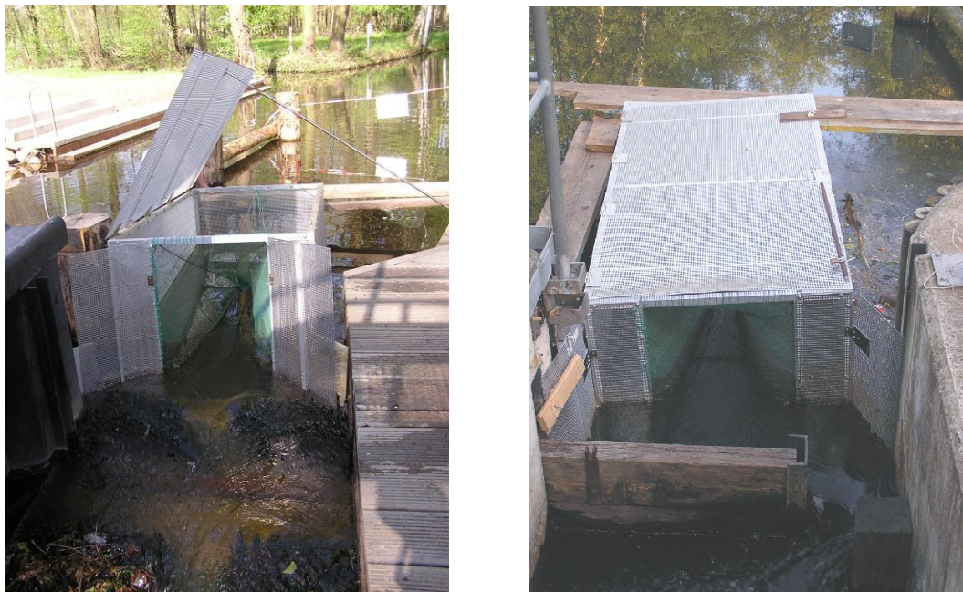
Abbildung 4-10: Lochblechreusen am Fisch-Kanu-Pass (links) und am Vertical-Slot-Pass (rechts)
