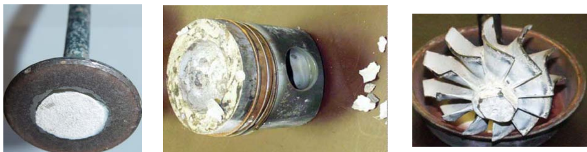
Abbildung 2: Siliziumablagerungen auf einem Ventil (links, eigenes Foto), einem Zylinderkopf und einer Turbine (Fotos Mitte und rechts, Beese, 2008)
