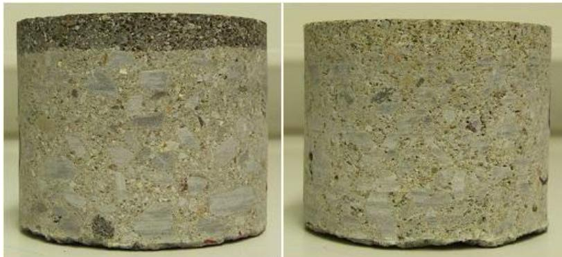
Abbildung 14: Gefügedichte Betonpflastersteine. Links: anthrazitfarbener, gefügedichteter Betonpflasterstein (Prototyp Gefda); rechts: grauer, gefügedichteter Betonpflasterstein (Prototyp Gefdg) [R11].
