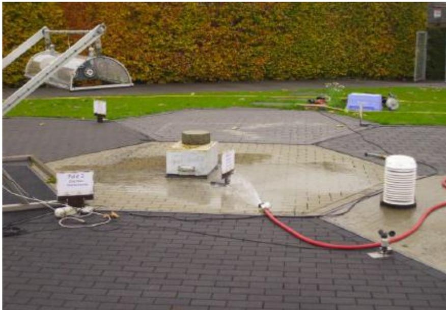
Abbildung 66: Aufsicht auf Messfeld 1 während der Beregnung über eine Schlauchdüse [H10].
