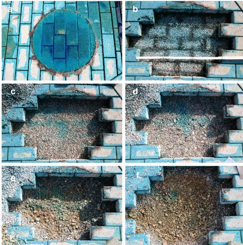
Abbildung 63: Verlauf der Färbung in unterschiedlichen Tiefen auf dem Messfeld 6 mit gefügedichteten Pflastersteinen im Geländeversuch I (a: Geländeoberkante; b: Bettungsschicht in 8 cm Tiefe; c: Bettungsschicht in 10 cm Tiefe; d: Tragschicht in 15 cm Tiefe; e: Tragschicht in 22 cm Tiefe; f: Tragschicht in 30 cm Tiefe) [B10].
