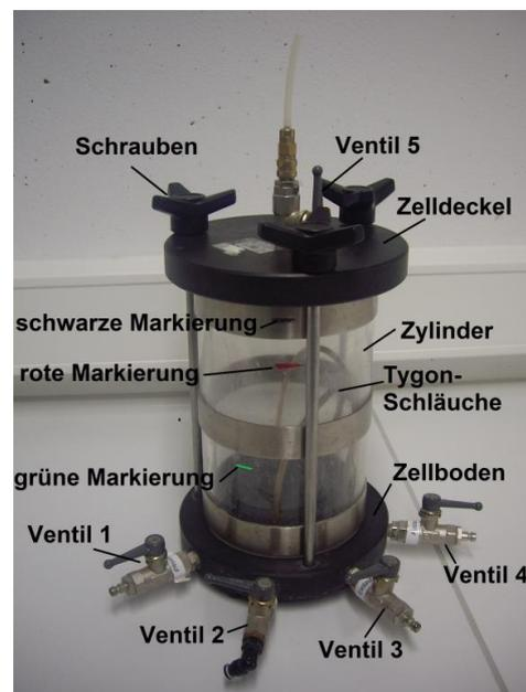
Abbildung 28: Foto der Triaxialzelle [R11].
