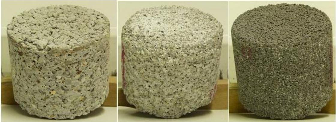
Abbildung 11: Haufwerksporige Betonpflastersteine mit unterschiedlichen Gesteinskörnungen. Links: Prototyp K (Hartkalkstein); Mitte: Prototyp S (Glas); rechts: Prototyp W (Blähschiefer) [R11].
