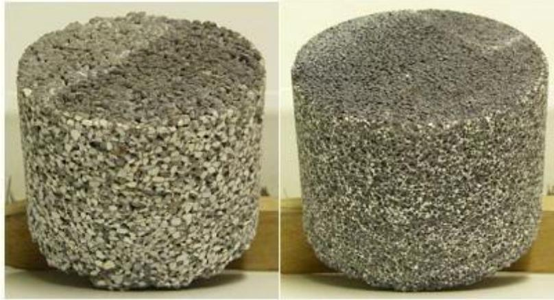
Abbildung 13: Eingefärbte haufwerkporige Betonpflastersteine; links: Prototyp G (anthrazit 2 %); rechts: Prototyp I (anthrazit 7 %) [R11].
