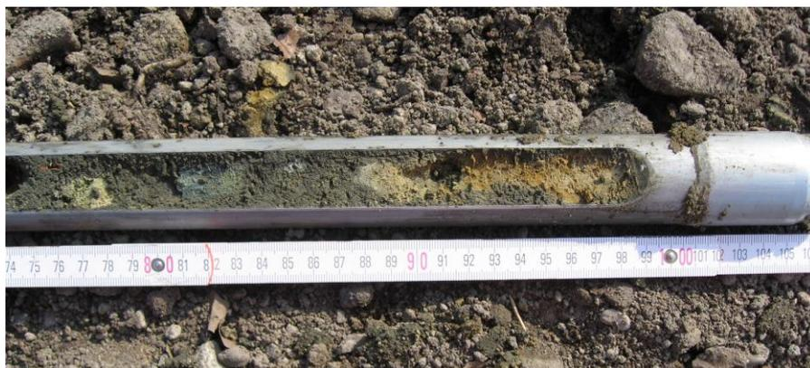
Abbildung 50: Bohrkerns aus der Rammkernsondierung.
