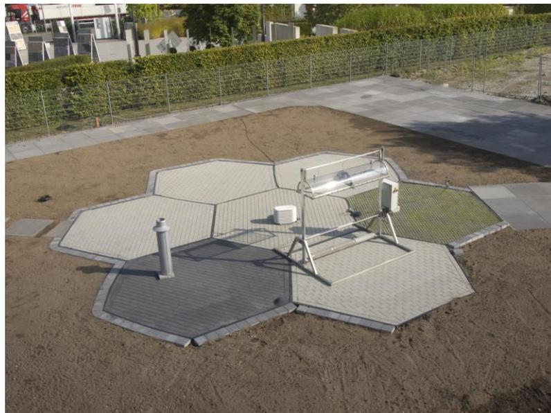
Abbildung 53: Schrägaufsicht auf die Untersuchungsfläche mit der Messfeldbelegung I (Geländeversuch I) zur Veranschaulichung des Fugenbildes.
