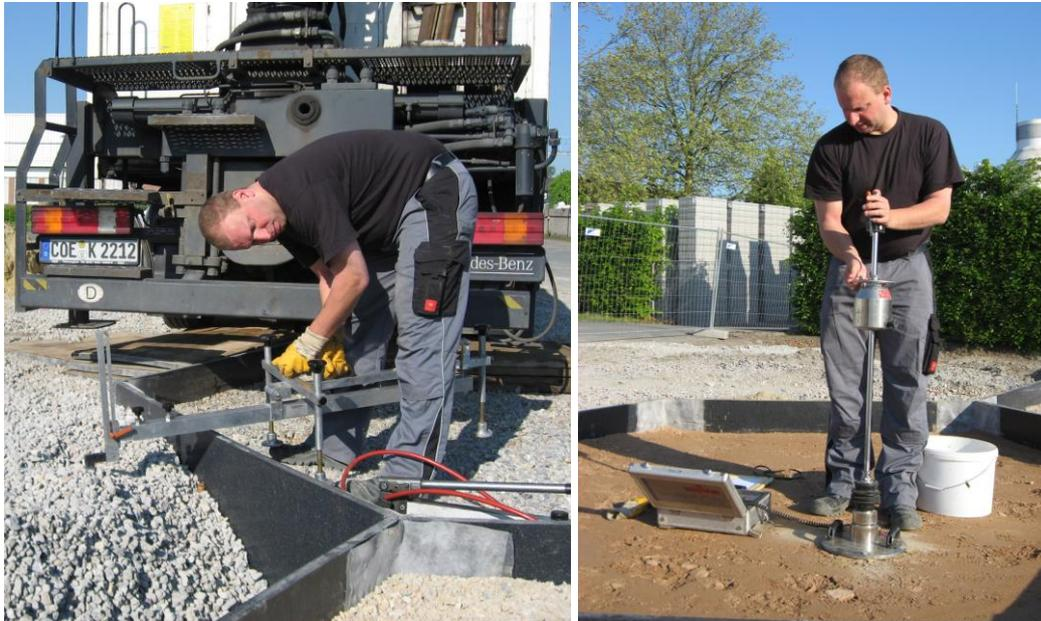
Abbildung 56: Durchführung des statischen Lastplattendruckversuchs (links) und des dynamischen Lastplattendruckversuchs (rechts) zur Ermittlung der Tragfähigkeit der Tragschicht an Messfeld 7.
