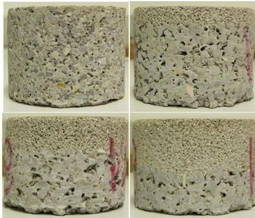
Abbildung 12: Haufwerksporige Betonpflastersteine mit unterschiedlich starker Vorsatzschicht. Links oben: Prototyp O (einschichtig); rechts oben: Prototyp Z (1 cm mächtige Vorsatzschicht); links unten: Prototyp T (2 cm mächtige Vorsatzschicht); rechts unten: Prototyp U (4 cm mächtige Vorsatzschicht) [R11].
