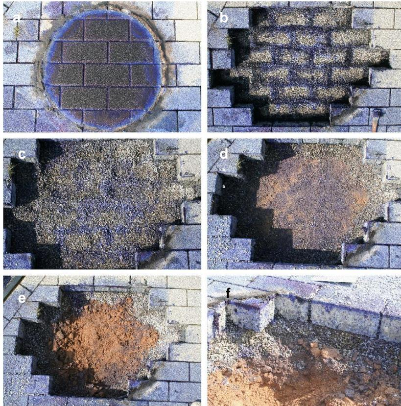
Abbildung 61: Verlauf der Färbung in unterschiedlichen Tiefen auf dem Messfeld 2 mit wasserdurchlässigen Pflastersteinen im Geländeversuch I (a: Geländeoberkante; b: Bettungsschicht in 8 cm Tiefe; c: Bettungsschicht in 10 cm Tiefe; d: Tragschicht in 18 cm Tiefe; e: Tragschicht in 24 cm Tiefe; f: Profilansicht) [B10].
