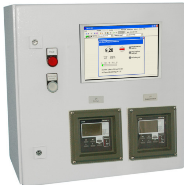
Abbildung 10: Vor-Prototyp des Kompaktschalterschanks
