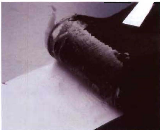
Abb. 8 Testverbunde Phylon-Testmaterial topy (links) und Phylon-TR-Gummi zur Prüfung von Verbundfestigkeiten
