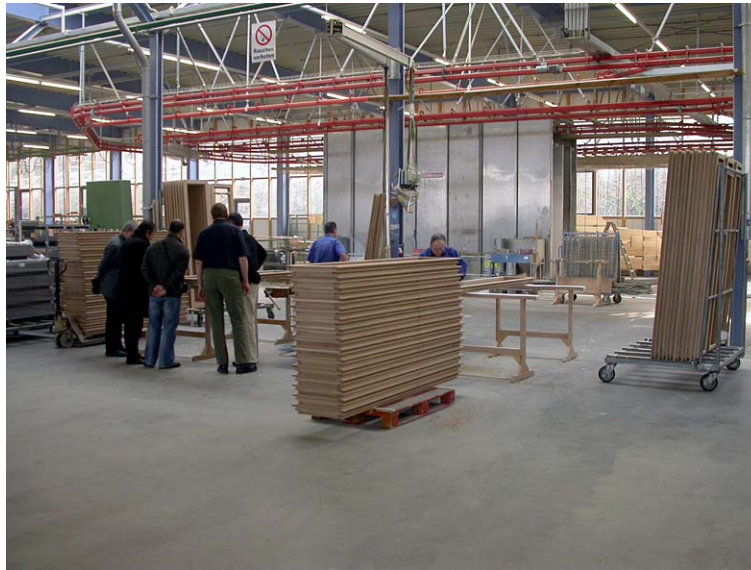
Abbildung 31: Begutachtung Fertigung elementierte Holzfassade
