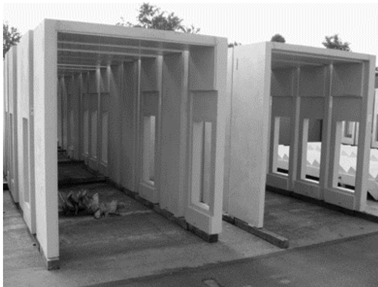
Abbildung 32: Bemusterung Produktion Türportale
