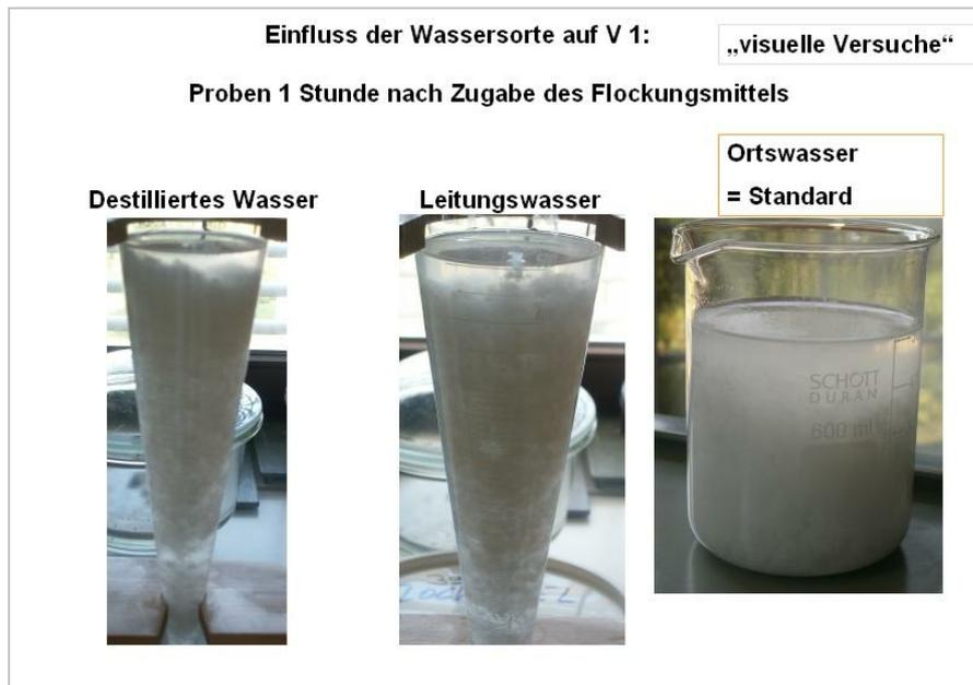
Bild 7b-A4: Visuelle Beurteilung der Flockung von V1 mit verschiedenen Wassersorten
