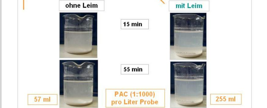
Bild 5: Einfluss von Leim auf Ladung und Flockungsqualität; visuelle Beurteilung nach Berechnung des Flockungsmittelbedarfs aufgrund von Ladungsmessungen in I-Standard. Werte für PAC: s. Anhang A1-Bild 2-A1. Natürlicher pH-Wert.
