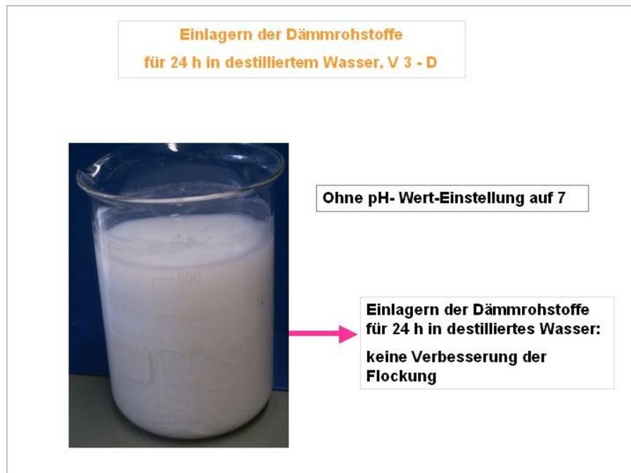
Bild 15-A4: Einlagern der Dämmrohstoffe für 24 Stunden in destilliertes Wasser; Einfluss auf die Flockungsqualität; visuelle Beurteilung
