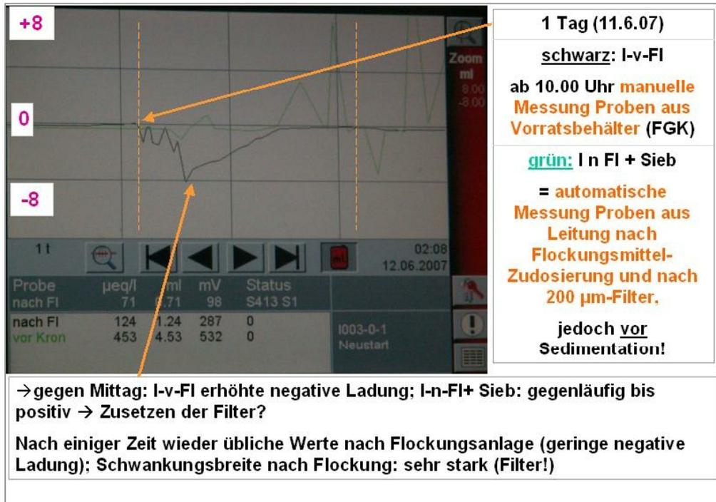
Bild 13a-A1: Vergleich der Ladung in I-v-FI mit I-n-FI; Messwerte im Display des On-line-Gerätes
