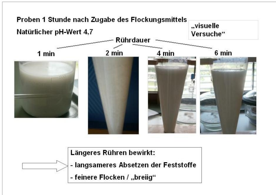
Bild 12-A4: Einfluss der Rührdauer nach Zugabe der Stärke auf die Flockungsqualität in V3-D bei natürlichem pH-Wert; visuelle Beurteilung
