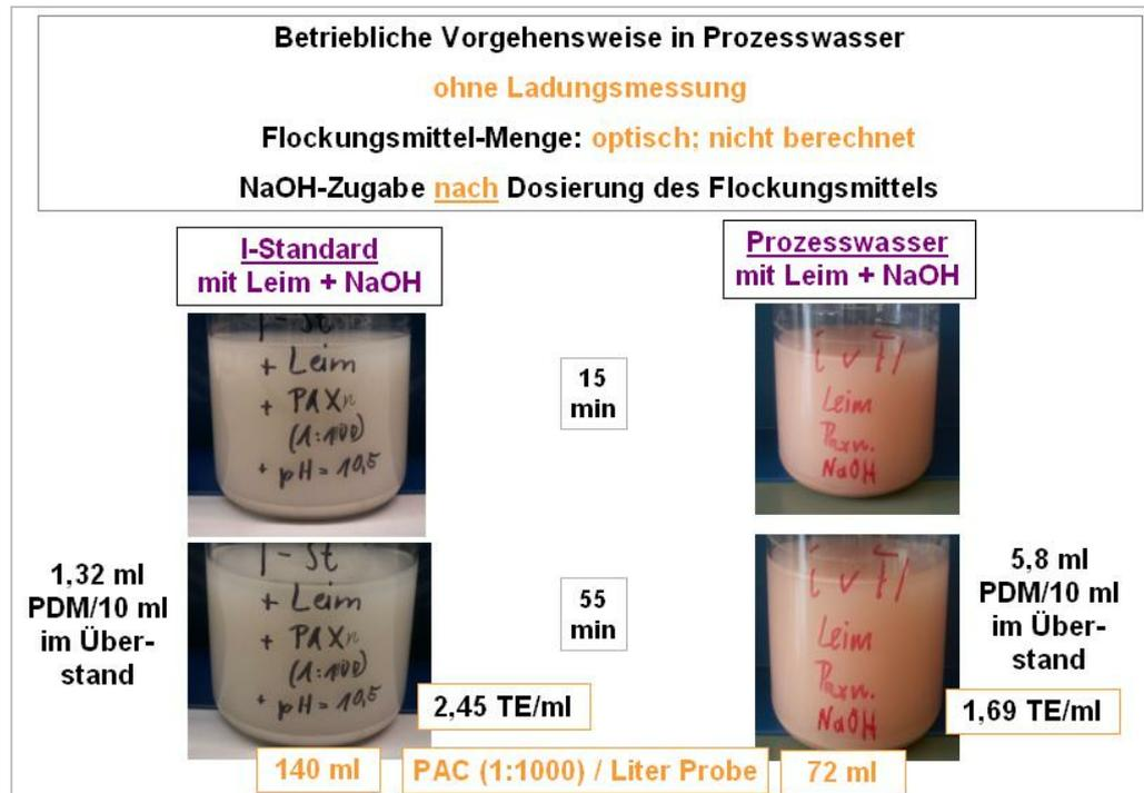
Bild 7-A1: Vergleich der Flockungsqualität, des Flockungsmittelbedarfs und der resultierenden Trübung in Prozesswasser bei erhöhtem pH-Wert; ohne und mit Leim. Links: I-Standard, rechts: Prozesswasser. Dosierung analog betrieblicher Vorgehensweise (optische Ermittlung der Flockungsmittelmenge; NaOH-Zugabe nach Flockungsmittelzugabe).
