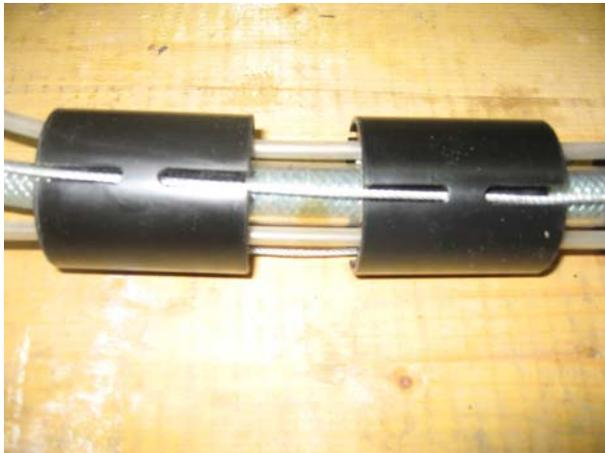
Unser Standardgerüst wird später noch mit einem selbsttragenden **Packer** für die Anbringung von Inlinern versehen. Hierzu haben wir einige Versuche unternommen, wohlwissend, dass es bei dem Funktionsmuster nicht auf die eingesetzten Materialien, sondern auf das Funktionsprinzip ankommt. Hierzu haben wir einige Musterstücke angefertigt bzw. anfertigen lassen.
