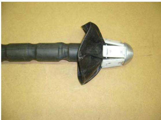
Wir haben das Produkt **BRAVOLINER FIX** eingesetzt. Unsere Versuche einen Hutaufsatz aus dem Kanalrohr heraus zu erstellen, sind auf der Probestrecke erfolgreich durchgeführt worden. Die Kanten waren rund und fest mit dem Untergrund verklebt.
