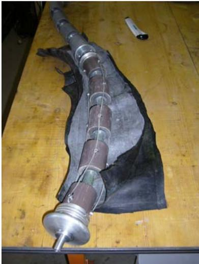
Unsere Versuche ein Packergrundgerüst zu erstellen, sind ausnahmslos gescheitert, denn das eingesetzte Material ist entweder unter Druck gerissen, oder hat dem Vulkanisierungsprozess nicht standgehalten. Weitere Probleme haben wir bei den Anschlüssen und bei den erforderlichen Materialstärken. Diese werden in einer weiteren Phase der Entwicklung geklärt.
