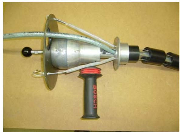
Nach anfänglich verschiedenen Modellaufbauten haben wir uns für die vorliegende Variante entschieden. Der Grundkörper wurde aus einer Aluminiumlegierung gedreht. Die Untere Manchette nimmt auch die Versorgungsleitungen auf. Die Steuerzüge werden mittels eines Tellers betätigt.
