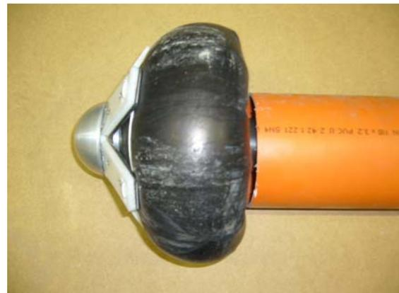
Dieser Kranz dient während des Aufblasens für die notwendige Presskraft und Verformung. Der aufgeblasene Balg nimmt bei dem Einsatz eine ovale Form an und dadurch kann das Material an den Untergrund gepresst werden. Die zweite Einsatzform des Kopfes ist die Dichtigkeitsprüfung, in der der Balg im Kanalquerschnitt aufgeblasen wird. Durch das
