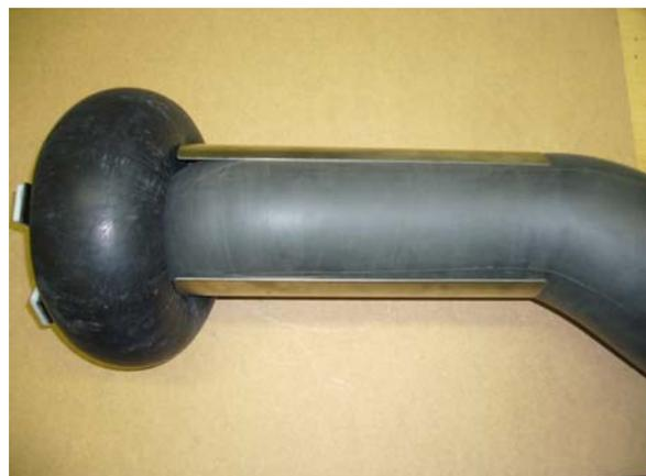
Die Bilder zeigen das bereits montierte Werkzeug beim Befahren der Probestrecke. Der Kopf wird am Einlauf aufgeblasen, oder jeweils der Aufgabe entsprechend, mit heißem Medium gefüllt. Der so positionierte Kopf übt auf das Hutprofilstück einen rückwärtsgerichteten Druck
