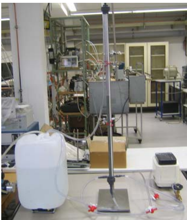
Abb. 4.8: Versuchsaufbau zur Untersuchung der Kinetik der Adsorption von Ammonium an Zeolith
