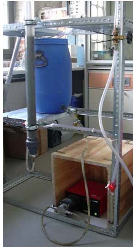
Abb. 4.13 u. 4.14: schematische Darstellung des Versuchsaufbaus zur Ermittlung der Bettexpansion in Abhängigkeit der Aufstromgeschwindigkeit bzw. des Durchflusses
