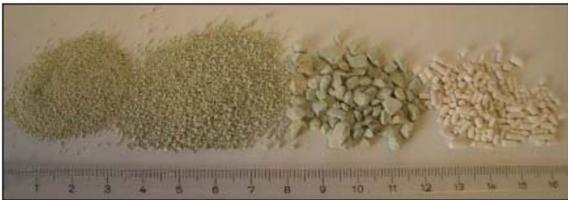
Abb.4.6: von links nach rechts: Klinoptiloith (Fa. Zeocem) in den Fraktionen 0,2-0,5mm, 0,5-1mm, 2,5-5 mm und synthetischer Zeolith (Fa. Süd-Chemie) der Fraktion 1,5mm.
