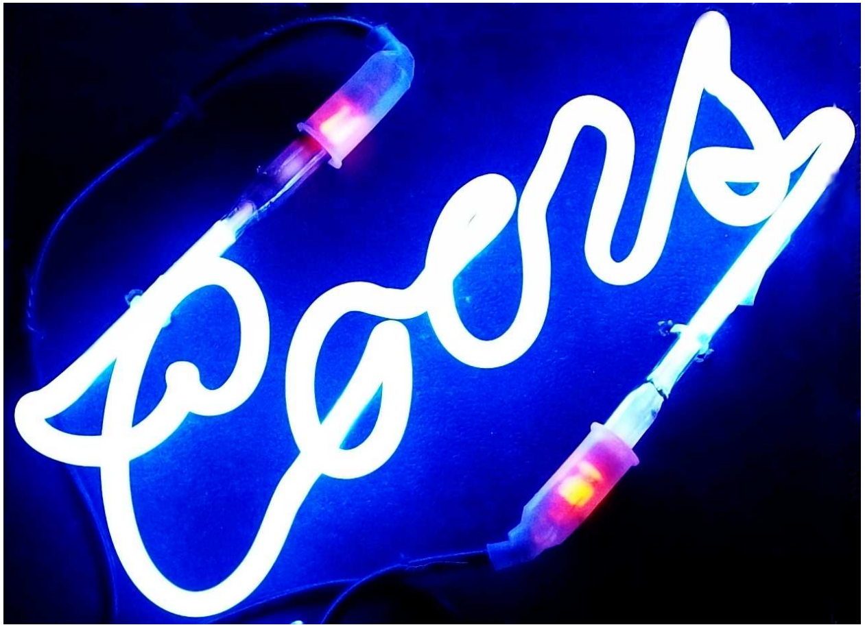
Funktionsfähige Hg-freie HS-Röhre mit Netzelektrode
