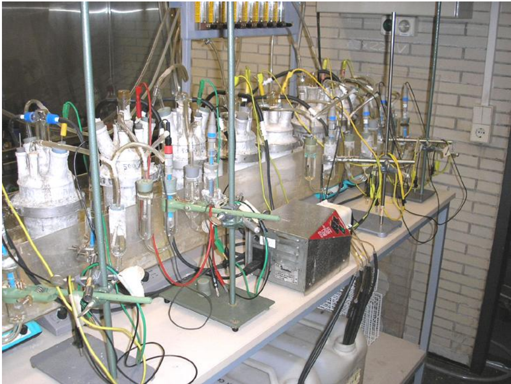
Abbildung 15: Aufbau der Bioreaktoranlage zur Ermittlung des freien Korrosionspotentials
