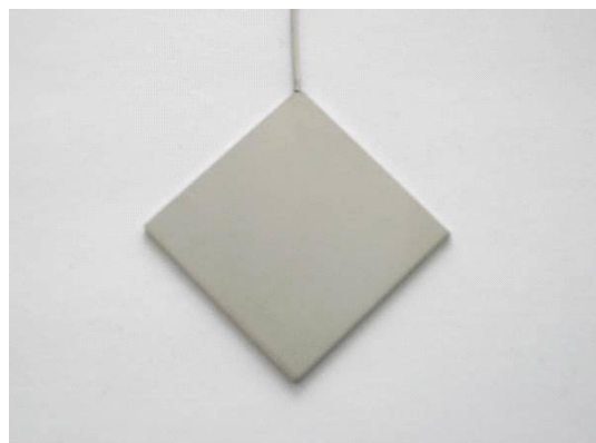
Abbildung 14: Aufnahme einer Edelstahl-MIC-Reaktor-Probe, 3cmx3cm, mit gelöteter Kontaktelektrode
