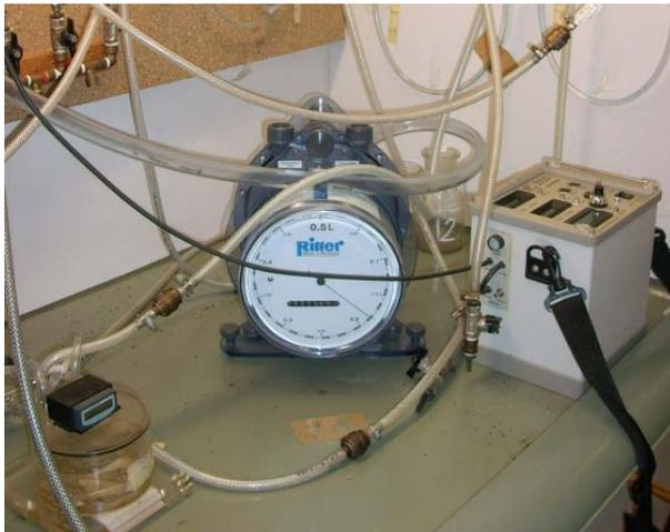
Abbildung 24: Milligascounter, Trommelgaszähler und Gasanalysegerät am Messplatz.
