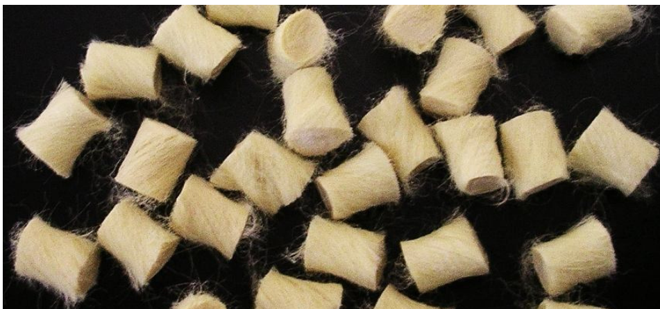
Bild 7: Pull-Drill-Granulat mit einem Aramidfaseranteil von 80%
