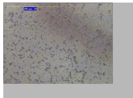
Bild 10: Poly-Dibenzyl-ProDOT-Schicht auf Quarzglas
