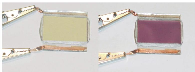
Bild 37: Elektrochromes Element mit Poly-DM-ProDOT und PB sowie ionenleitender PVB-Folie in verschiedenen Färbungszuständen: links: +0,8 V: farblos, rechts: -0,8 V: violett mit  $10 \text{ cm}^2$  aktiver Fläche
