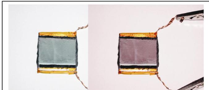
Bild 14: Photo eines elektrochromen Elementes mit  $\text{WO}_3$  und Poly-N-Benzyl-EDOP, links:  $\text{WO}_3$  reduziert, rechts  $\text{WO}_3$  oxidiert
