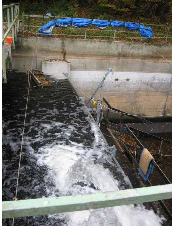
II. Testanlage voll (Treibklotz schwimmt)
