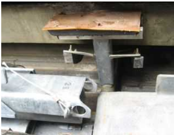
Abbildung 24: Dichtkissen für die Dichtung unter dem Deckel
