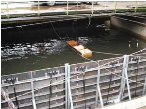
I. Treibklotz wird vor die Wand gezogen
