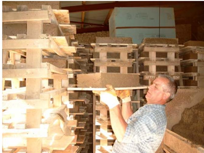
Bild 16: Befüllen der Regele mit frisch produzierten Lehmsteinen
