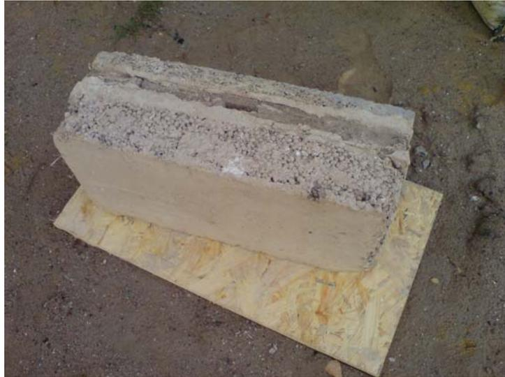
Bild 11: Hier wurde ein Lehmstein aus 7 Schichten produziert und vier verschiedene Materialien wurden miteinander verbunden.
