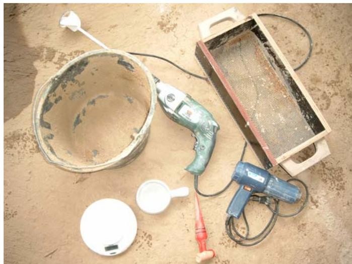
Bild 25: Benötigt werden folgende Gerätschaften für den Aufschlammtest: 2 Stück 20l Eimer, Bohrmaschine zum Aufrühren der Rohlehmschlämme, 5mm Sieb, Einsinkinstrument, Waage mit einer Genauigkeit von Plus/Minus 1 g, keramische Trocknungsschale, Heißluftföhn
