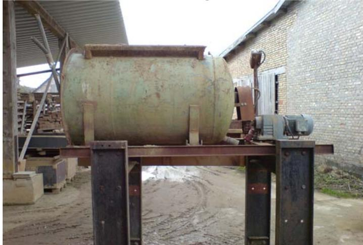
Bild 3: Der eingeweichte Rohlehm wird von den Vorschlämmtainern in einen Zwangsmischer gefüllt und dort zu einer homogenen Schlämme aufrührt
