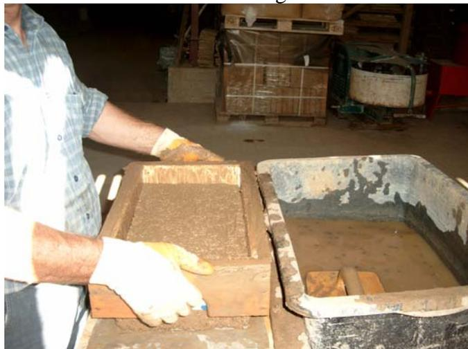
Bild 15: Abziehen der Produktionsform und Ablegen im Wasserbad
