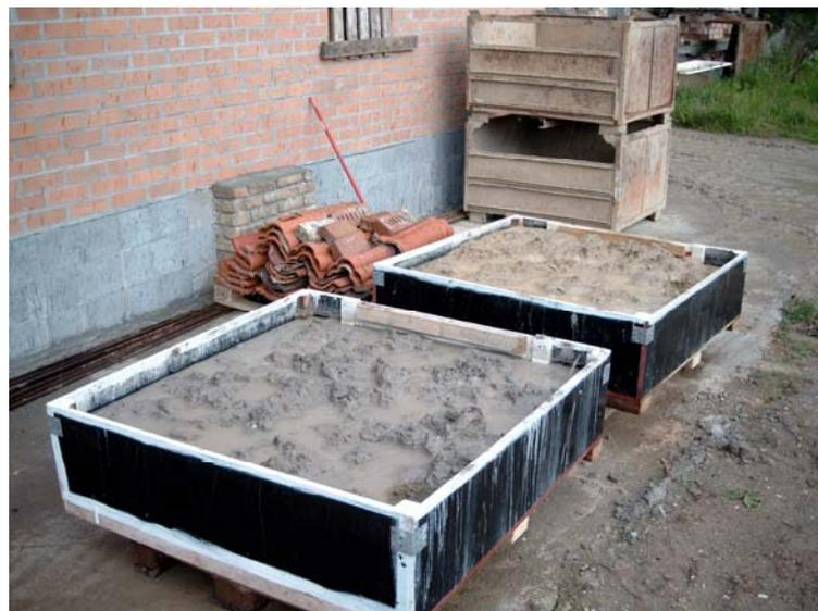
Bild 2: Rohlehm wird in Vorschlämmcontainer eingesumpft
