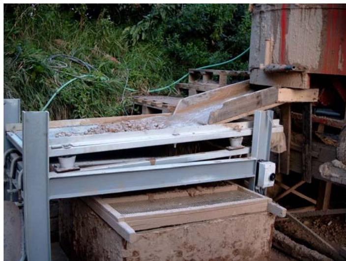
Bild 5: Siebung der Rohlehm Schlämme
