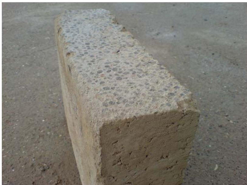
Bild 17: Nachgeschnittene Lagerfuge der großformatigen Lehmsteine
