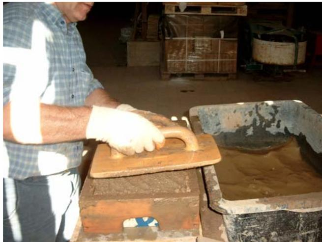
Bild 14: Auffüllen der Form und Abreiben der Oberfläche
