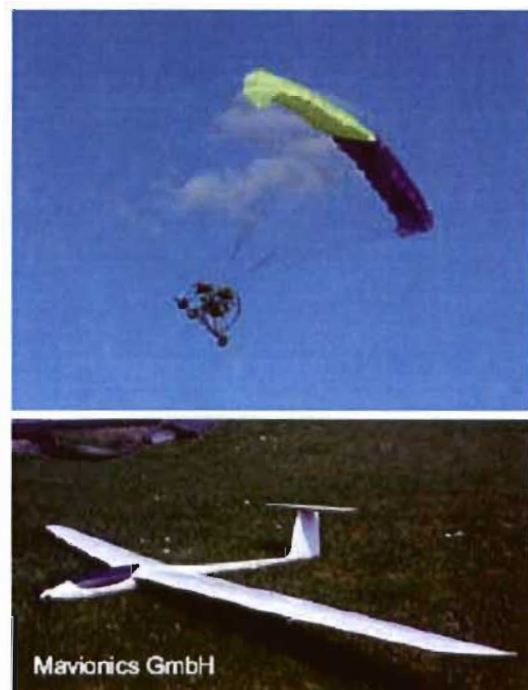
Abbildung 25: Gleitschirm Drohne (o.) und Starrflügler Drohne (u.)
