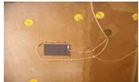
Wärmestromplatte und Kombisensor
