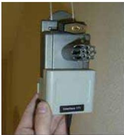
Abb. 49: Messgerät für Raumklimadaten
