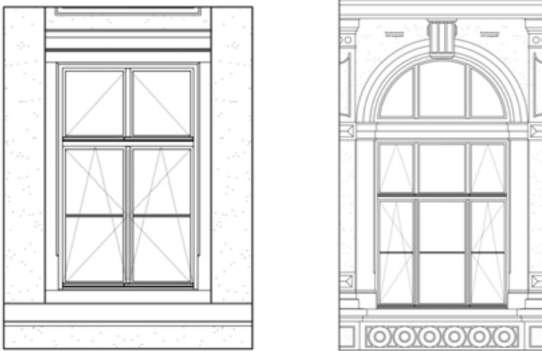
Abb. 44: Normalfenster mit historischer Teilung und Rekonstruktion der Rundbogenfenster im Mittelrisalit
