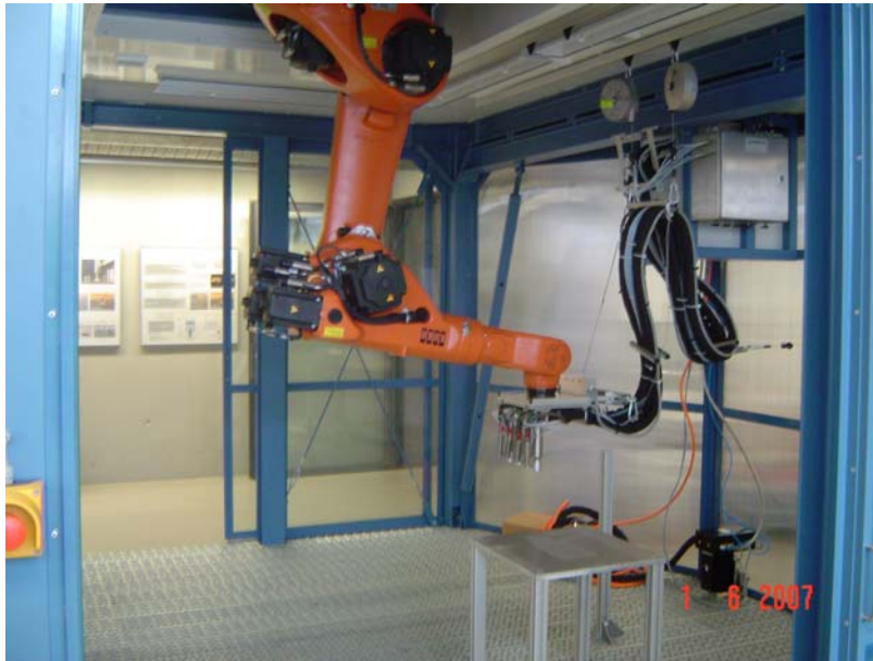
Abbildung 6: Robotergeführte Atmosphärendruckplasma-Anlage zur Erprobung der Plasmadüsen für 3-D Geometrien
