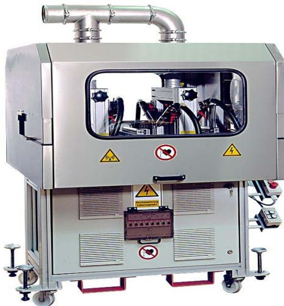
Abbildung 5: Vorbehandlungsstation zur Reinigung und Aktivierung durch mehrere AD-Plasmadüsen
