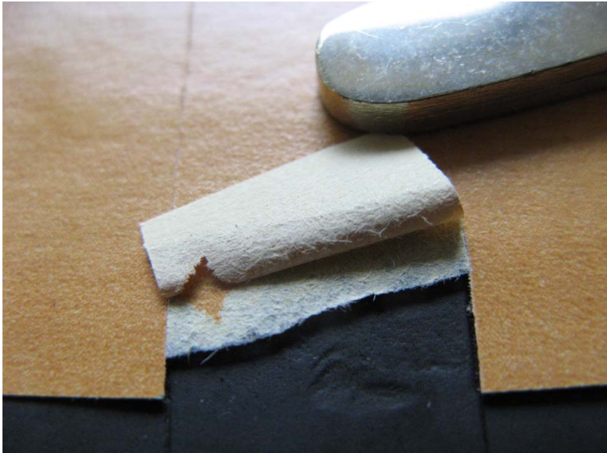
Abbildung 8: Kohäsives Versagen des Dekorpapieres beim Kleben auf PU-Schaum
