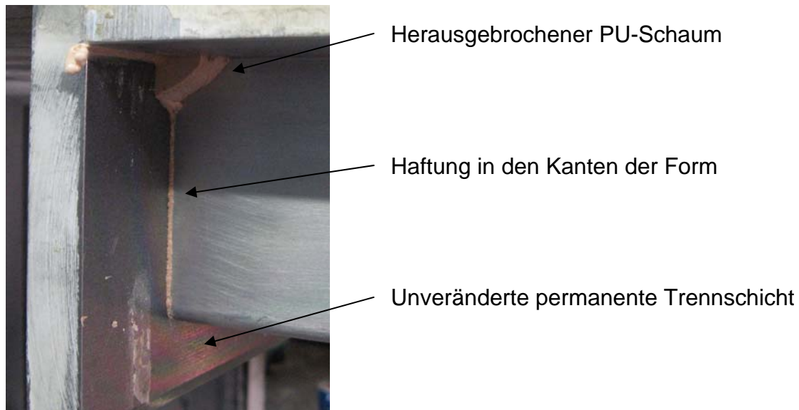
Abbildung 13: Nach Abformung auf der Form verbliebene PU-Reste
