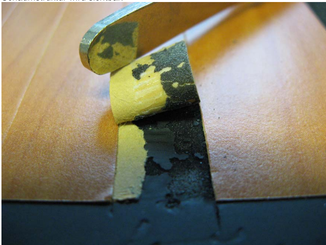
Abbildung 10: Mischbruch einer guten Klebung des Dekors auf dem PU-Schaum
