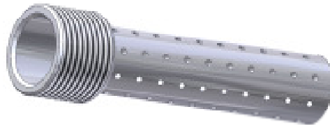
Abbildung 10: Dreidimensionale Darstellung eines zylindrischen Luftverteilers
