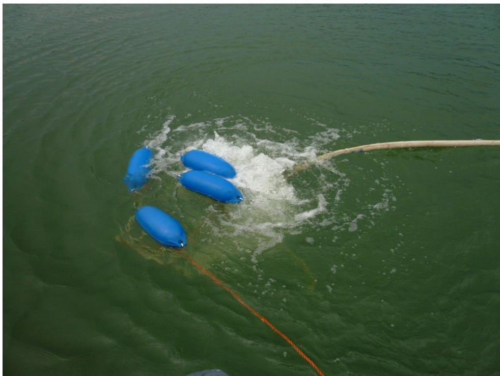
Abb. 1: Der getauchte Ausströmer in Betrieb, er wird mittels Schwimmern auf etwa 40 cm Tiefe gehalten.
