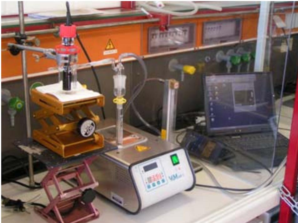
**Abb. 4:** Apparatur zur Bestimmung der Oxidationsstabilität
