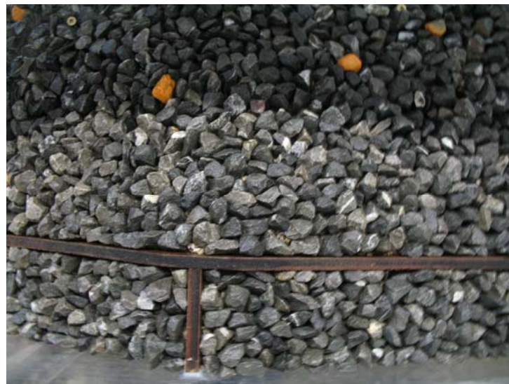
Abb. 6-55: fertig gestellter Steinsatz im Modellversuch - Draufsicht auf die Seitenstruktur
