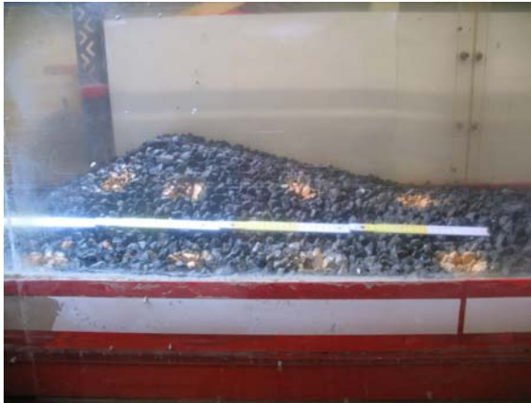
Abb. 6-57: Ansicht des Versuchs mit eingebauter Schwachstellen (gelb markiert)
