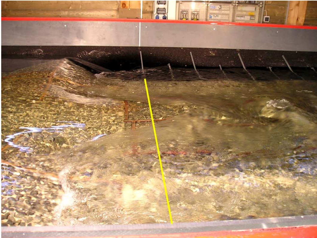
Abb. 6-32: Strömung in der Tosmulde bei Q = 560 \text{ m}^3/\text{s} - optimierte Variante C
