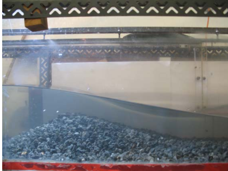
Abb. 6-56: Q_{\text{Halbmodell}} = 90 \text{ l/s} entspricht Q' = 910,7 \text{ m}^3/\text{s} bzw. \frac{Q'}{Q^*} = 3,07
