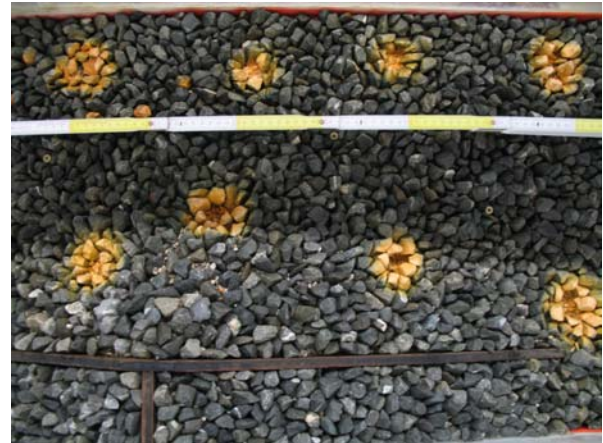
Abb. 6-58: Draufsicht auf die eingebauten Schwachstellen (gelb markiert)
