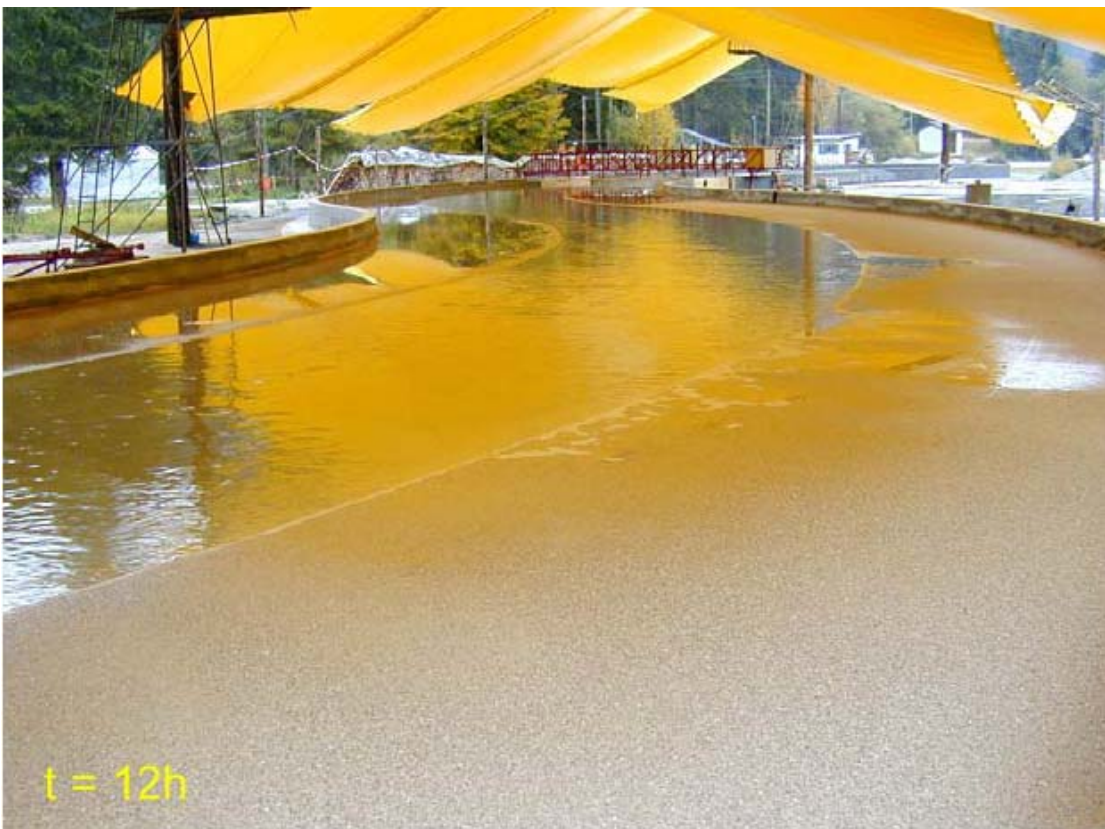
Abb. 8-10: Geometrie des Modellversuchs KV1 und Photo während des Versuchsbetriebs Die Abb. 8-11 zeigt die Breitenentwicklung nach 20 Naturtagen für die Messung und die beiden Simulationsvarianten. Die typischen Prallufer–Furt–Prallufer Entwicklung wird auch in der tiefengemittelte 2D-Simulation nicht zufrieden stellend abgebildet, wenn hier keine Sekundärströmungskorrekturen verwendet werden. Mit Sekundärströmungskorrekturen
