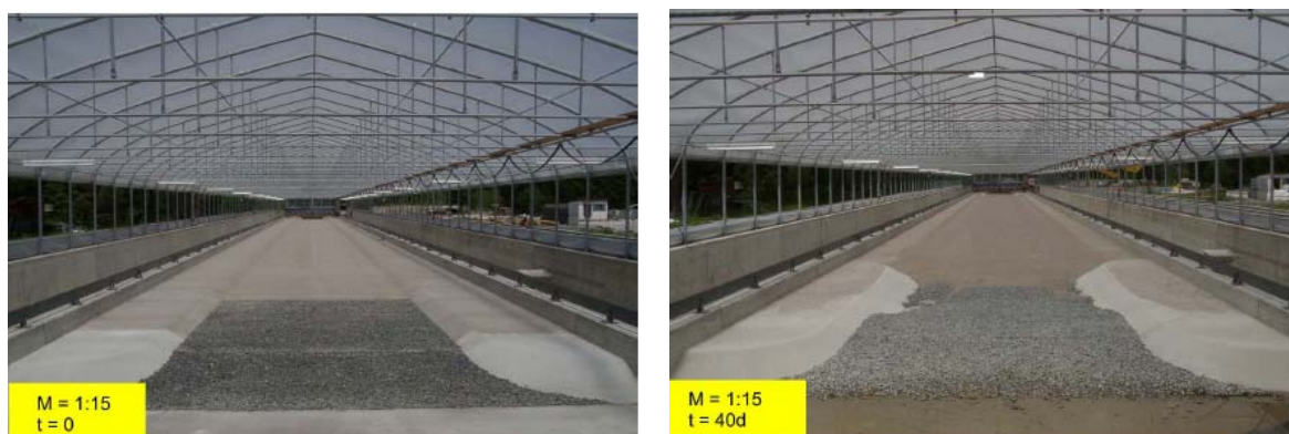
Abb. 8-5: Einlaufbereich des Modellversuchs – Blick in Fließrichtung – zu Beginn und nach 40 Tagen
