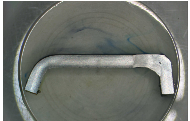
Abb. 20: Schliffpräparat aus nebenstehendem Stahlstück. Länge: 36mm; Dicke: 3mm
