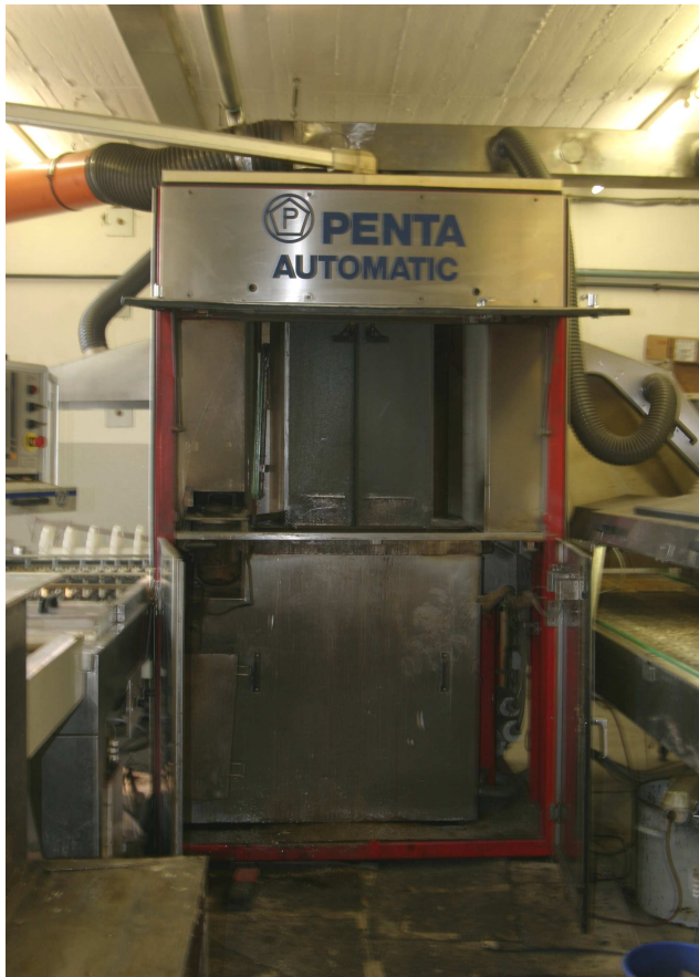
Aufgeklappter unterer Bereich der Verzinnungsmaschine mit Lottiegel
