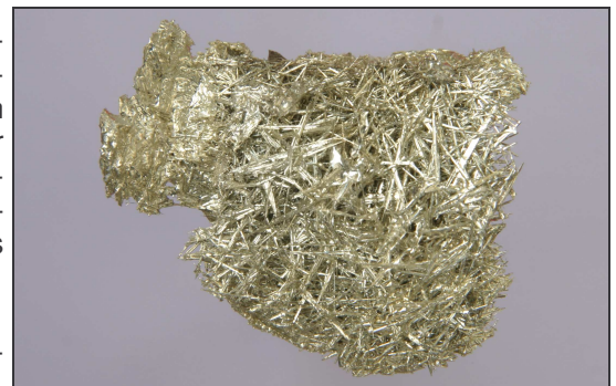
Intermetallische Kupfer-Zinn – Verbindung ( \eta -Phase)
