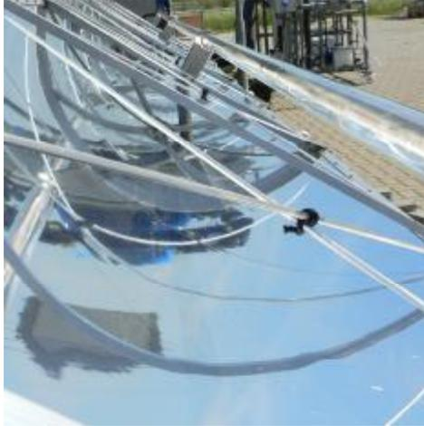
Abbildung 8: Parabolrinne mit Blick in den Parabolspiegel während des Betriebes
