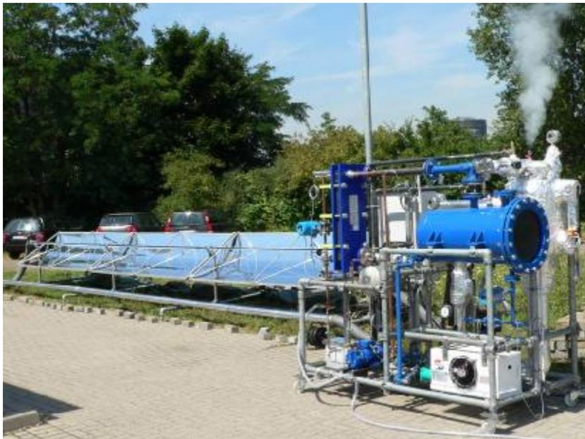
Abbildung 6: Solar DSKM bei der Inbetriebnahme des Dampfprozesses
