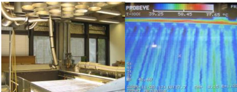
Abbildung 28: VRK bei den Versuchsfahrten am Kollektorteststand
