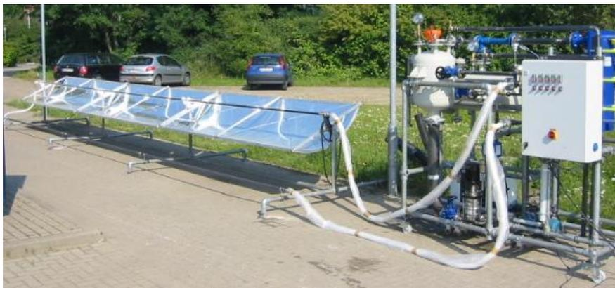
Abbildung 5: Solar DSKM, Dampfprozess nicht isoliert
