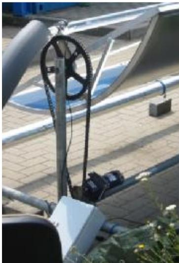
Abbildung 12: Nachführung des Parabolrinnenkollektors
