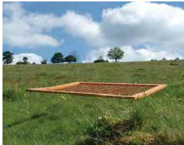
**Abb. 45:** Der Holzrahmen mit 10 cm x 10 cm Unterteilung aus gespannten Schnüren besitzt genau die Größe einer Probefläche und vereinfacht das Schätzen von Deckungswerten (TREISCH 2008).
