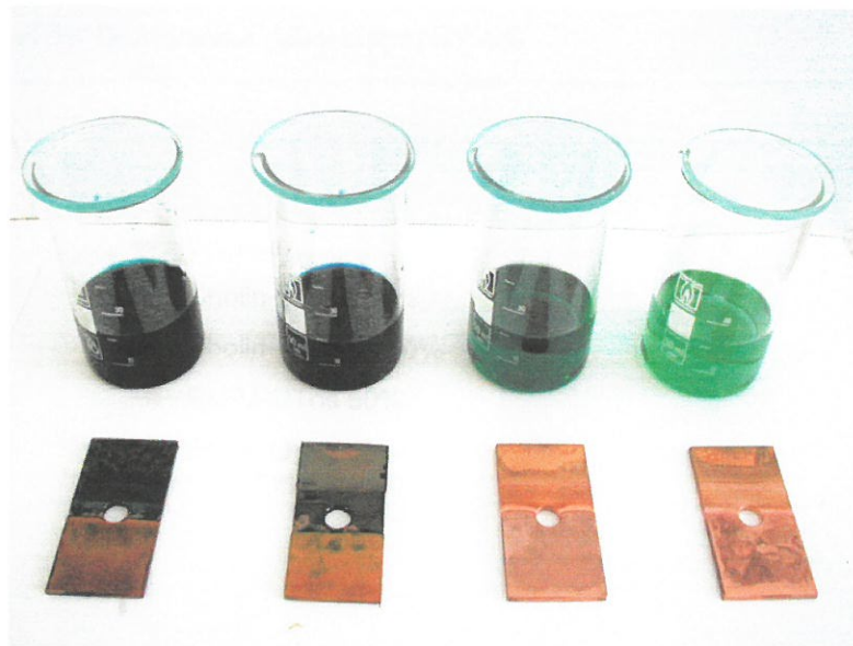
Abb. 19: Korrosionstest an Kupfer nach 672 Stunden (28 Tagen)
