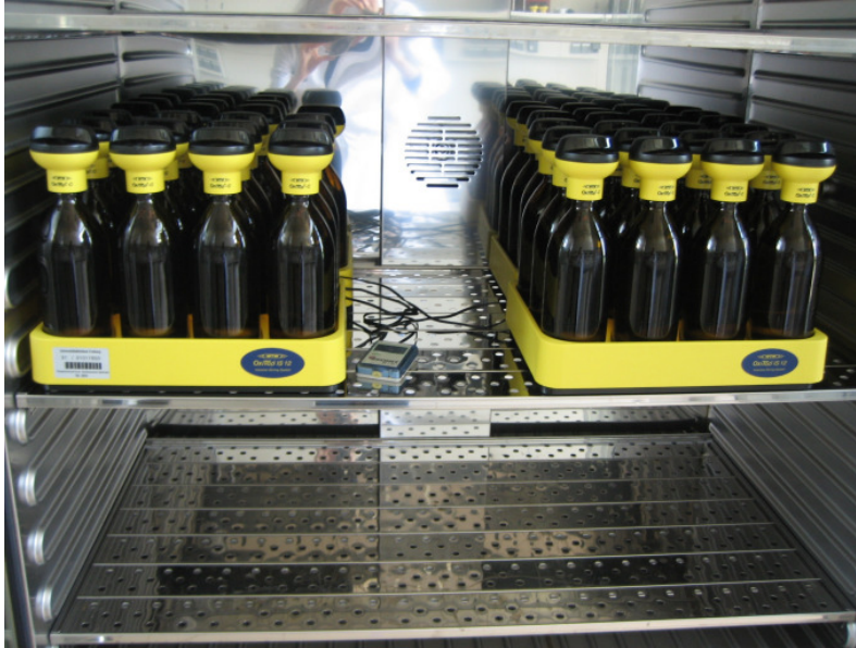
Abbildung 3-2 Messsystem von WTW für den Manometrischen Respirationstest
