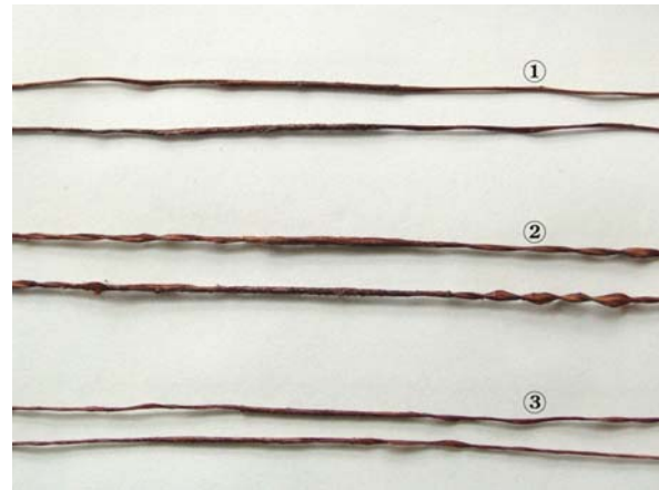
Abb. 12: Verklebung von Aramidspleißen mit Epoxidharz modifizierter RFL, RFL beschichtet
