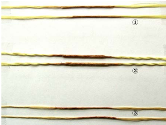
Abb. 11: Verklebung von Aramidspleißen mit Epoxidharz modifizierter RFL
