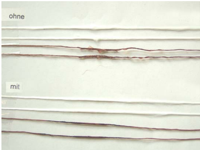
Abb. 3: Polyamidgarn vor und nach der Behandlung der Spleißknoten
