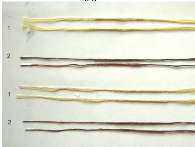
Abb. 8: Verklebung von Aramidspleißen mit Neopren Latex, Beschichtung mit RFL
