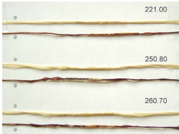
Abb. 4: Verklebung von Aramidspleißen mit verschiedenen Schmelzklebstoffen, Technora 1670 x 1 z 200 K 119.518-1
