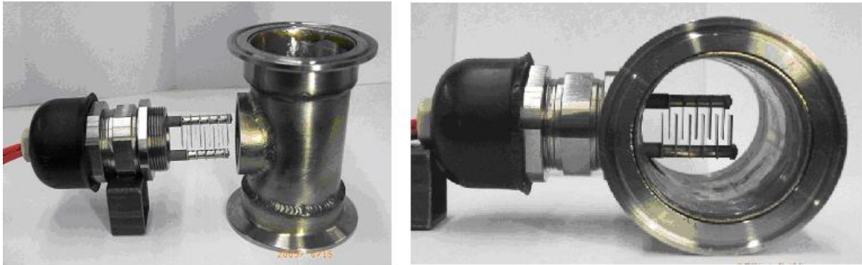
Abb.: 2-8 Neukonstruktion des Ladungssensor mit Rohrflanschen
