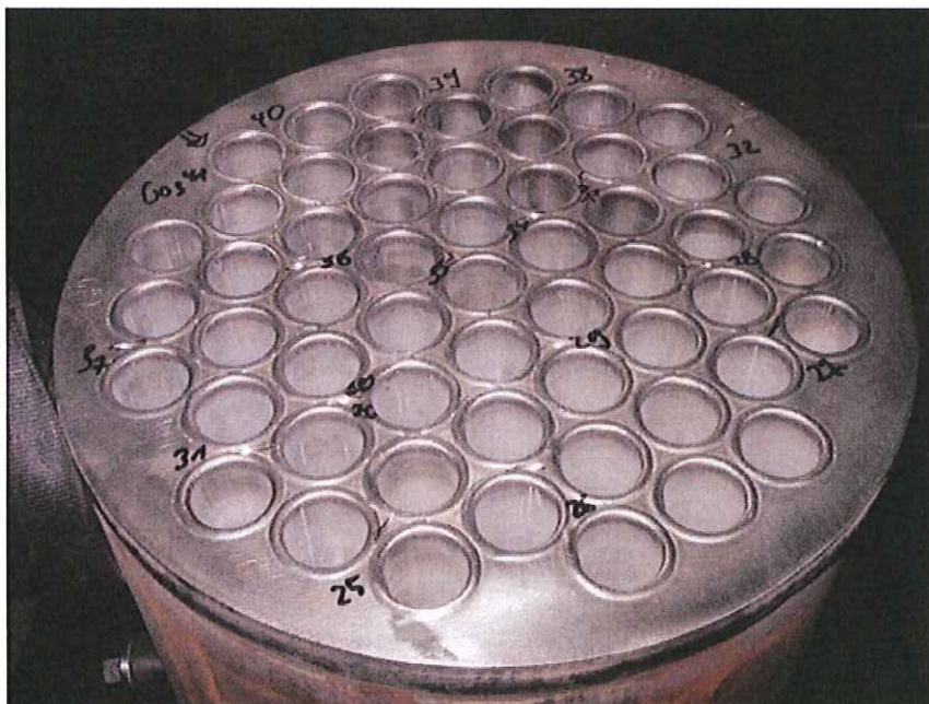
Abbildung 19: Heiße Rohrplatte des Wärmeübertragers 2. Kennzeichnung und Einfräsung von 16 Lötstellen vor der Hartlötung. Thermoelemente eher kreisförmig angeordnet.
