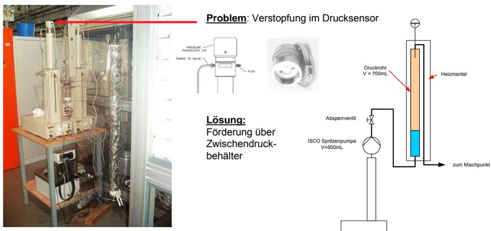
**Abbildung 45:** Förderkonzept zur Einspeisung von Pflanzenfett in die kontinuierliche Technikumsanlage
