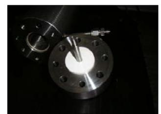
**Abbildung 52:** Aufbau des kontinuierlich durchströmten Mikrowellenreaktors
