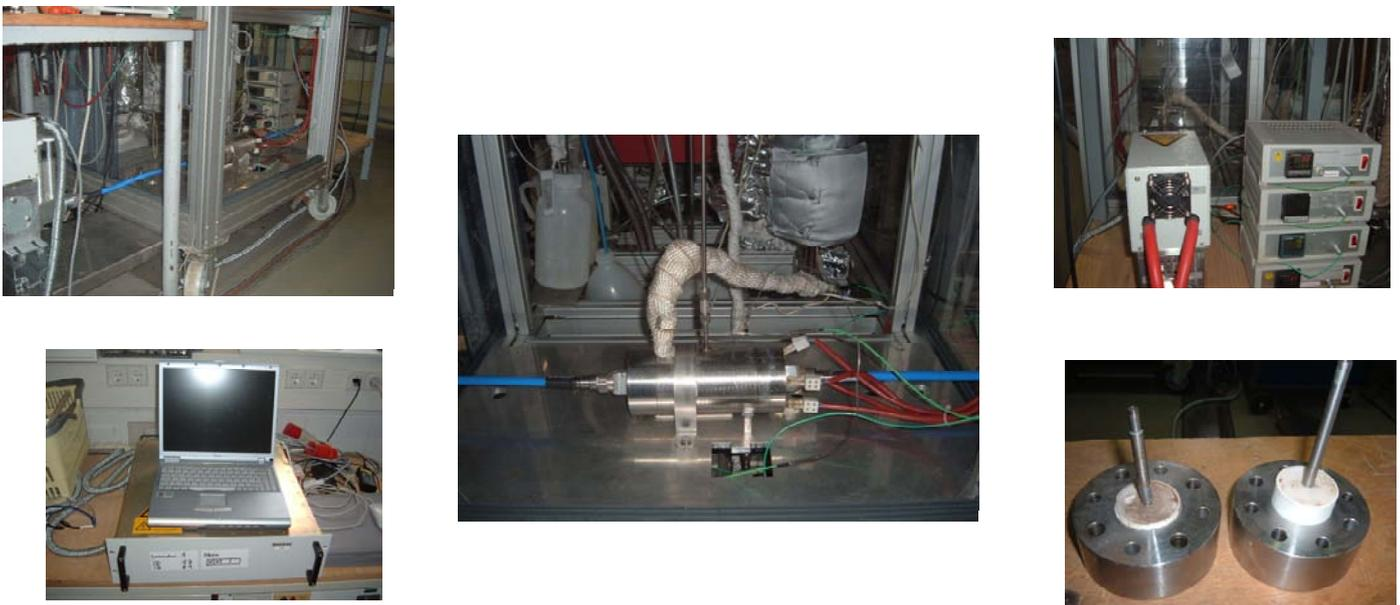
**Abbildung 53:** Mikrowellenreaktor im eingebauten Zustand, sowie Peripheriegeräte (rechts oben + links unten: Magnetronansteuerung:
