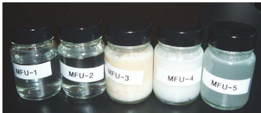
**Abbildung 56:** Produktproben der Mikrowellen gesteuerten Fettsplaltungen
