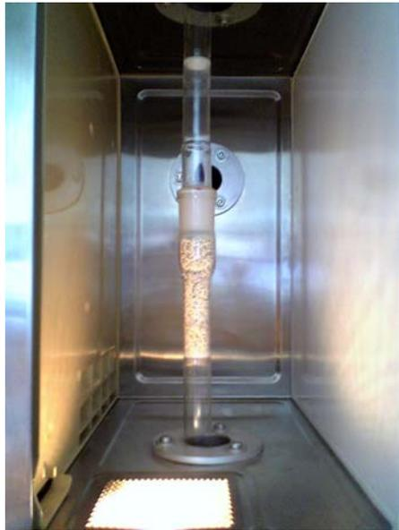
**Abbildung 29:** Glasreaktor für die kontinuierlichen Versuche in der Mikrowellenapparatur
