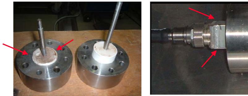
**Abbildung 57:** Undichtigkeitsstellen des Mikrowellenreaktors (links Bornitrid-Abdichtung; rechts: Magnetronankoppelung)
