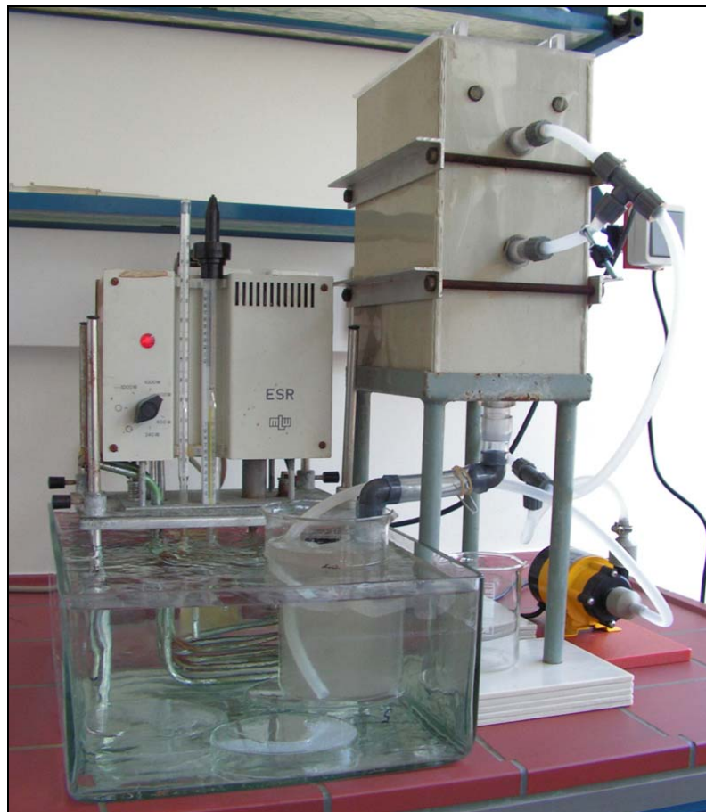
Abbildung 1: Apparatur zur Entfettung nach dem Spritzverfahren
