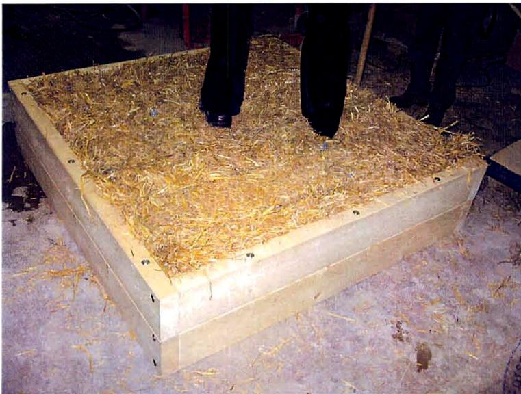
Bild 2: Durch Herstellung des Probekörpers im Liegen wird eine sehr gute Verkeilung der Ballen erreicht. Die dann noch vorhandenen Hohlräume im Bereich der Stoßstellen der Ballen werden mit losem Stroh zugestopft.
