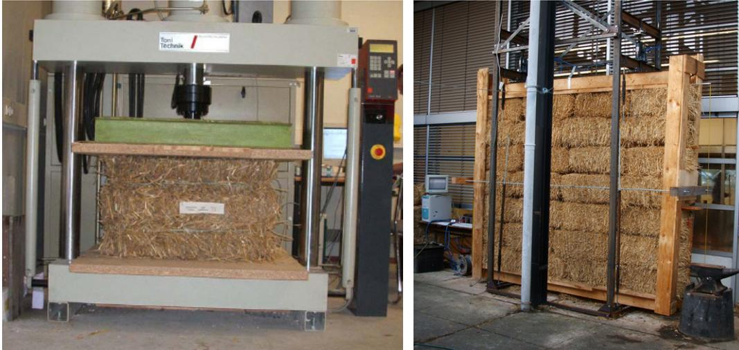
Belastungseinrichtung für Einzelballenversuche (l) und für Wandversuche (r) ZUB
