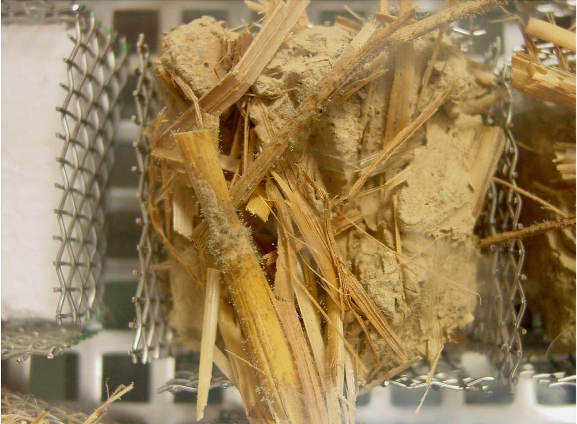
Bild 10-3: Der Stroh-Lehmputz-Verbund aus der Inkubationseinheit 2.3 (25°C, 95%) nach Ablauf der Beobachtungsdauer, Pilzwachstum über den gesamten Prüfkörper verteilt sichtbar.
