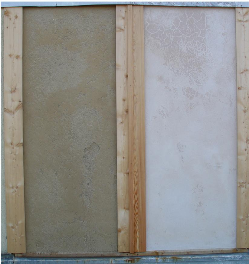
Bild 10-11: Lehmputzfläche (links) mit Auswaschungen, Kalkputzfläche (rechts) mit Rissen im oberen Teil.
