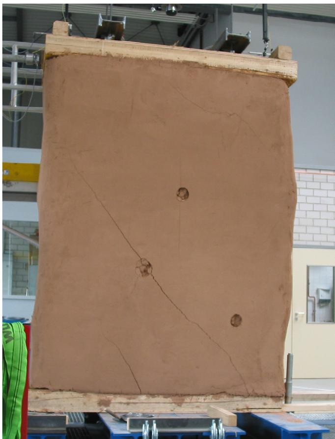
Abbildung 5-7: Wand 1 nach Schubversuch
