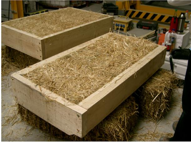
Abb.: 5 (l.) Herstellung der Wandecke für den SBI- Test
