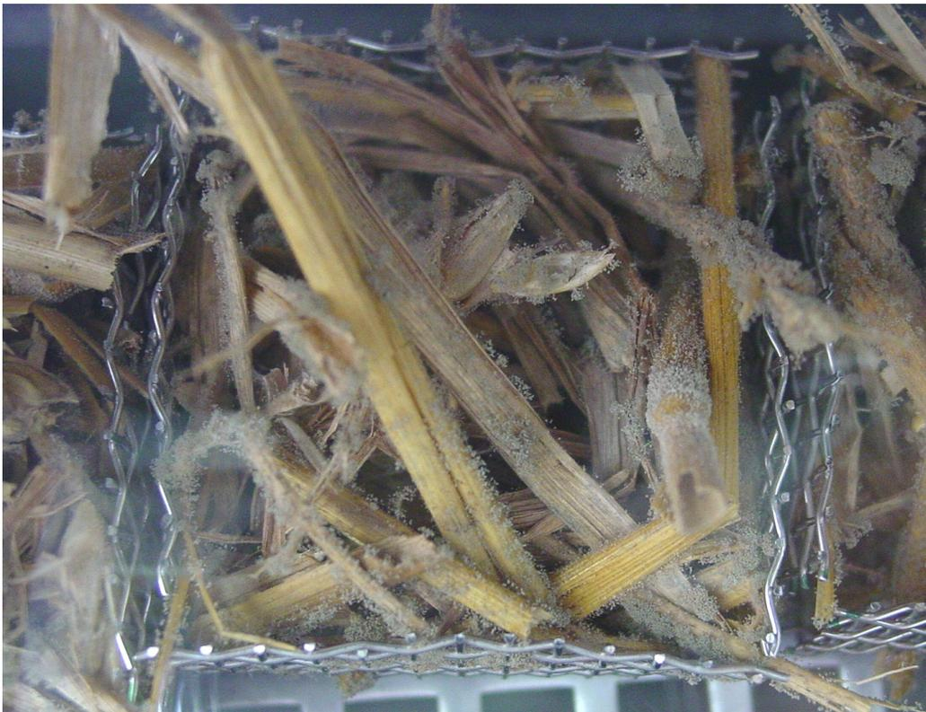
Bild 10-2: Das Stroh aus der Inkubationseinheit 2.3 (25°C, 95%) nach Ablauf der Beobachtungsdauer, Pilzwachstum über den gesamten Prüfkörper verteilt sichtbar.
