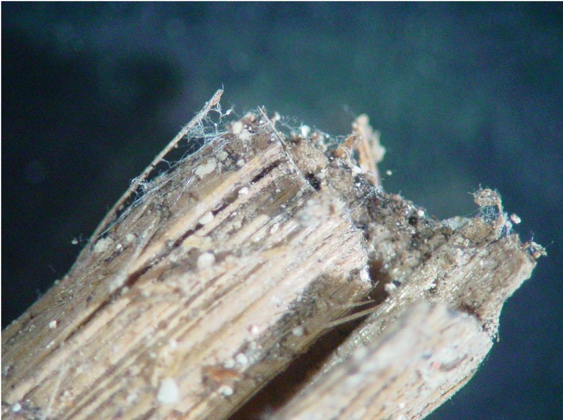
Bild 10-24: Hyphen eines Saprophyten auf einem Halm aus der Kalkputzwand im Auflichtmikroskop
