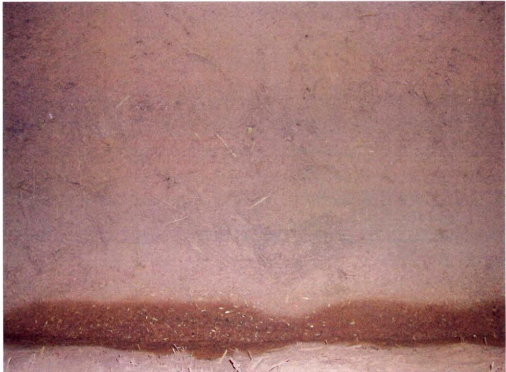
Befestigung des Prüfmaterials im SBI-Prüfstand, Versuch 3
