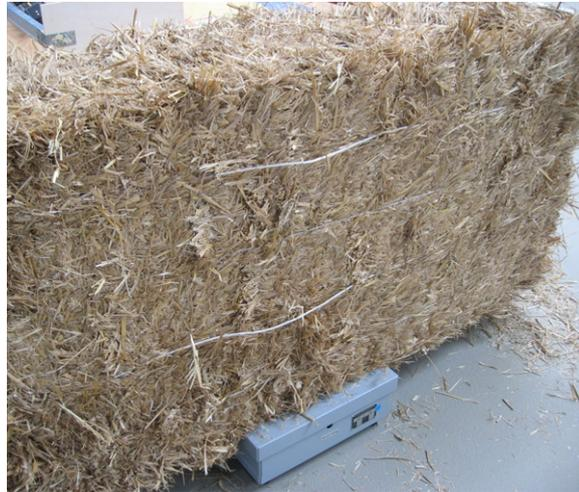
Abbildung 3-16: Erntegarnausfall unter Gebrauchsspannung, Pos 1.6 Strohballen Nr. 6 nach Durchtrennen von 2 Erntegarnen, nach Versuchende gekippt
