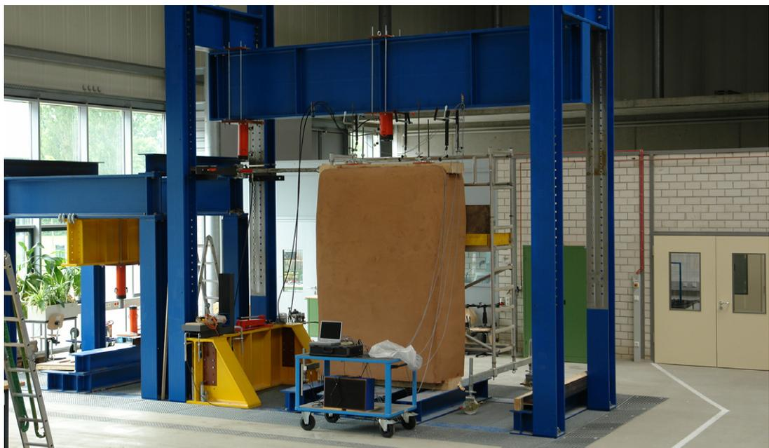
Versuchstand für Druck- und Schubversuche an verputzten Strohballenwänden
