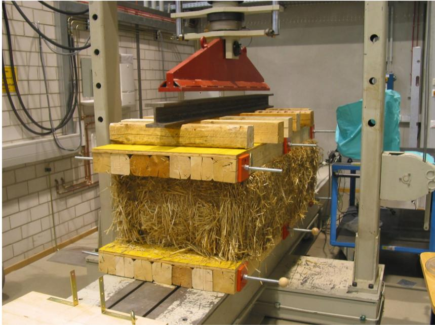
Abbildung 3-5: Versuchseinrichtung für Kriechversuche
