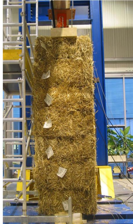
Abbildung 4-9: Wand 2 im Kurzzeit-Druckversuch
