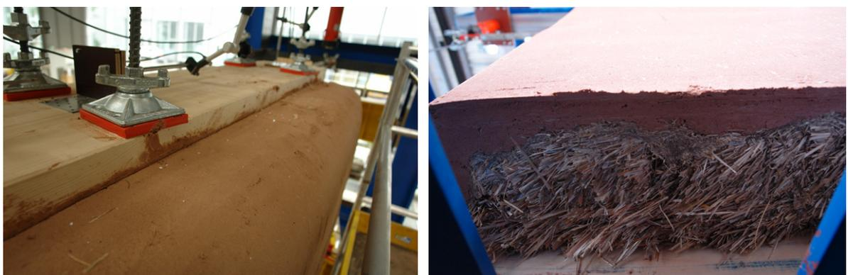
Abbildung 5-2: Anschluß des Putzes an Rähm und Schwelle, Wand 2
