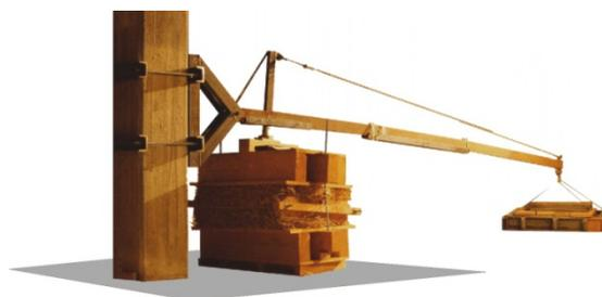
Abbildung 3-4: Kriechprüfstand
