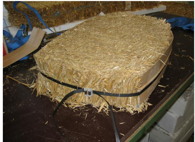
Abb.: 8 Probenvorbereitung für die Lambdamessung
