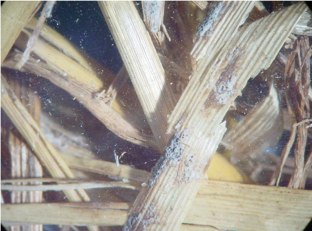
Bild 10-16: Befallener Getreidehalm aus dem Strohballen (Ausgangsmaterial) im Auflichtmikroskop.
