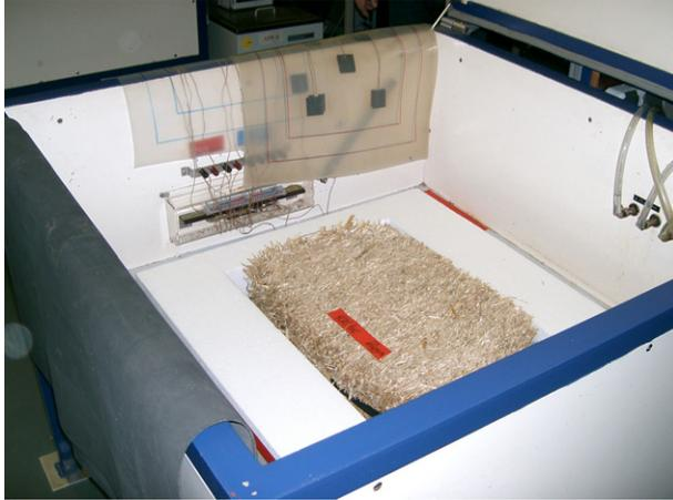
Abb.: 7 Probevorbereitung für Wärmeleitfähigkeitsmessung
