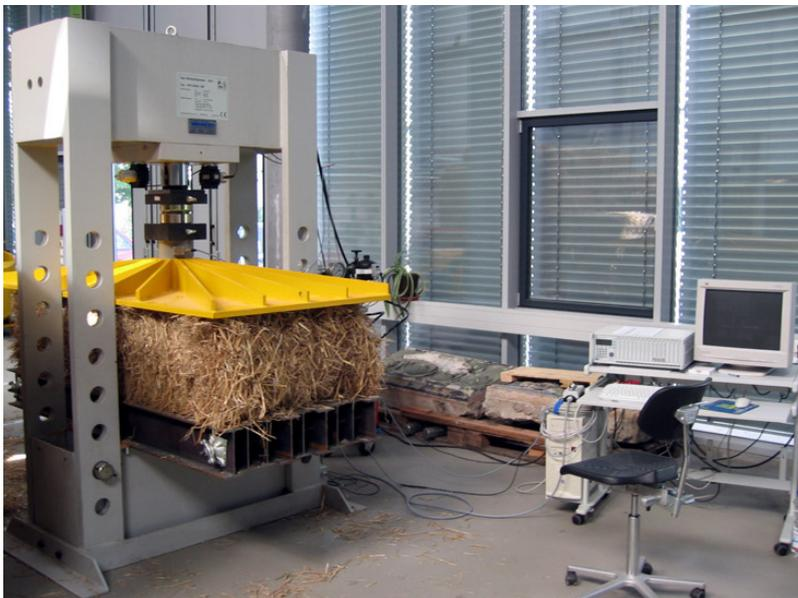
Abbildung 2-3: Prüfstand I „Yale“ mit Meßeinrichtung
