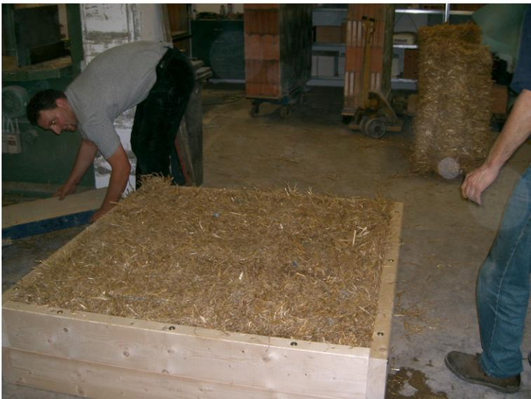
Abb.: 10 Vorbereitung der Prüfwand Messung der Wärmedurchlasswiderstand am FIW München durch Architekt Olaf Eggers und Zimmerermeister Ulrich Schmidt
