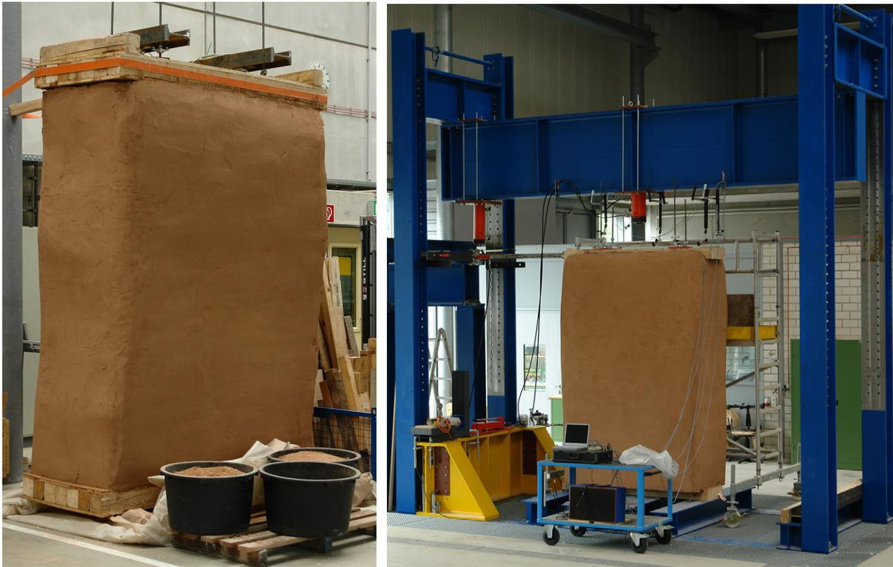
Abbildung 5-3: links: Verputzte Wand 1 rechts: Verputzte Wand 2 im Prüfstand
