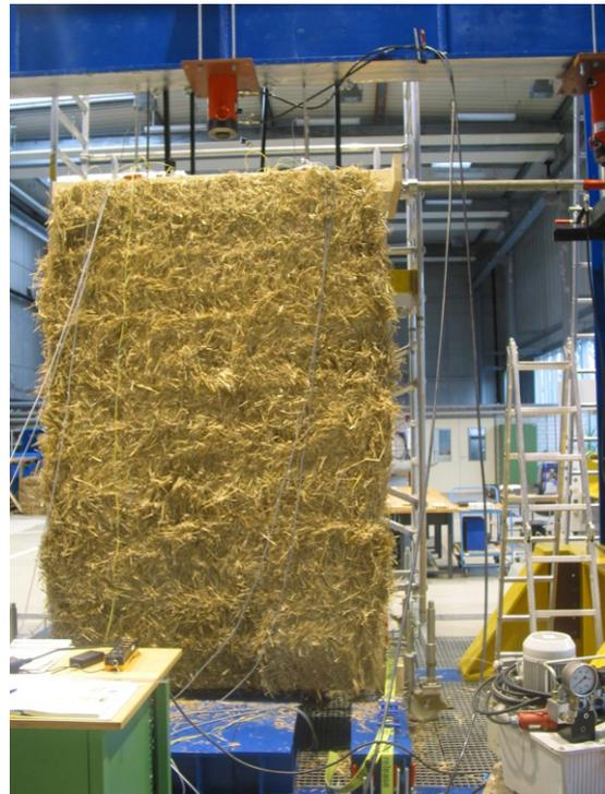
Abbildung 4-11: Versuchseinrichtung – Schubbelastung der Wände
