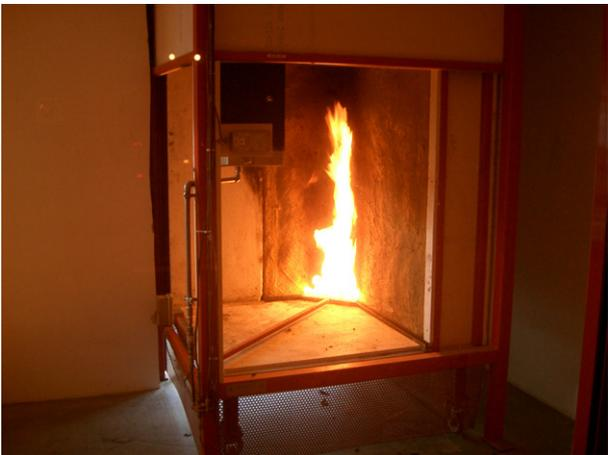
Abb.: 3 (l.) Erster SBI- Test nach EN 13823 am 30.05.07
