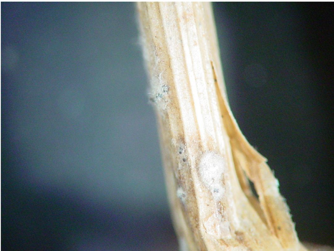
Bild 10-22: Pilzreste an Getreidehalm von einer Strohprobe der Lehmputzwand im Auflichtmikroskop
