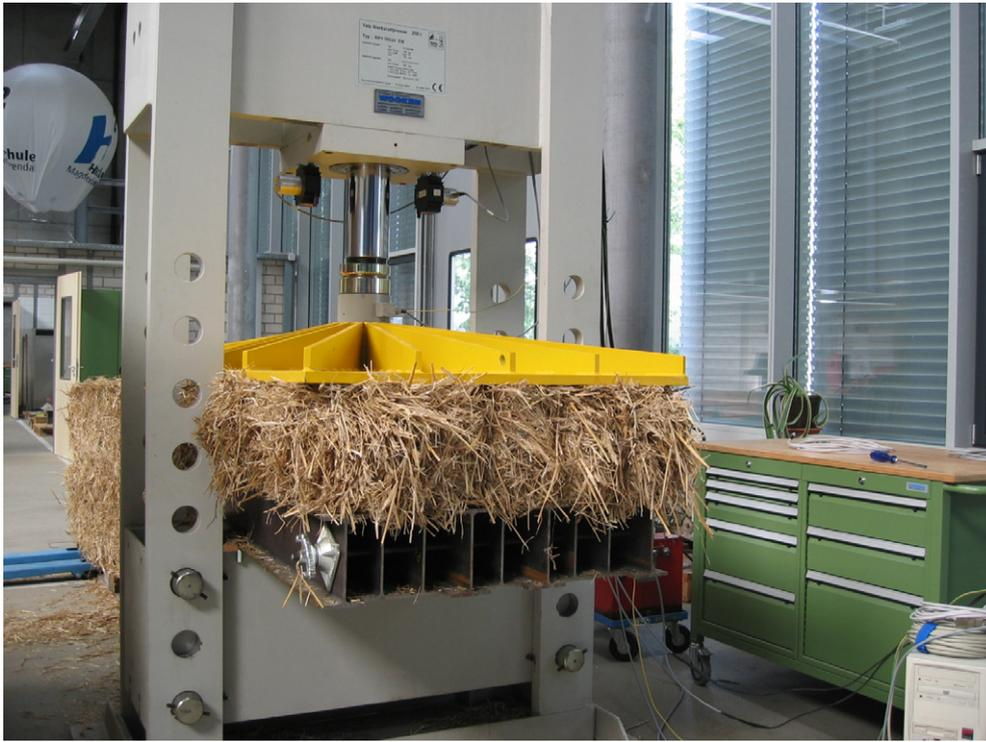
Abbildung 3-1: Druckversuch an Einzelballen, Pos 1.1, Prüfstand Yale, Ballen 2, bei  $\epsilon \sim 50\%$
