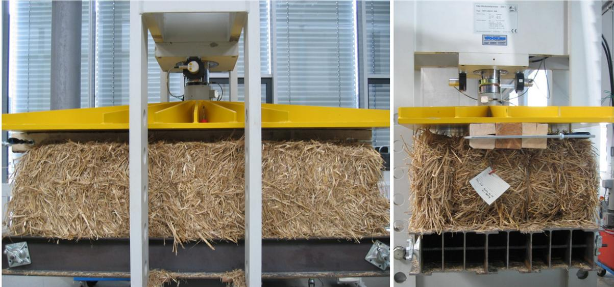
Abbildung 3-22: Druckversuche mit Einleitung der Druckkraft über Teilflächenpressung Pos. 1.9, Ballen 24 mit aufliegendem Rähm
