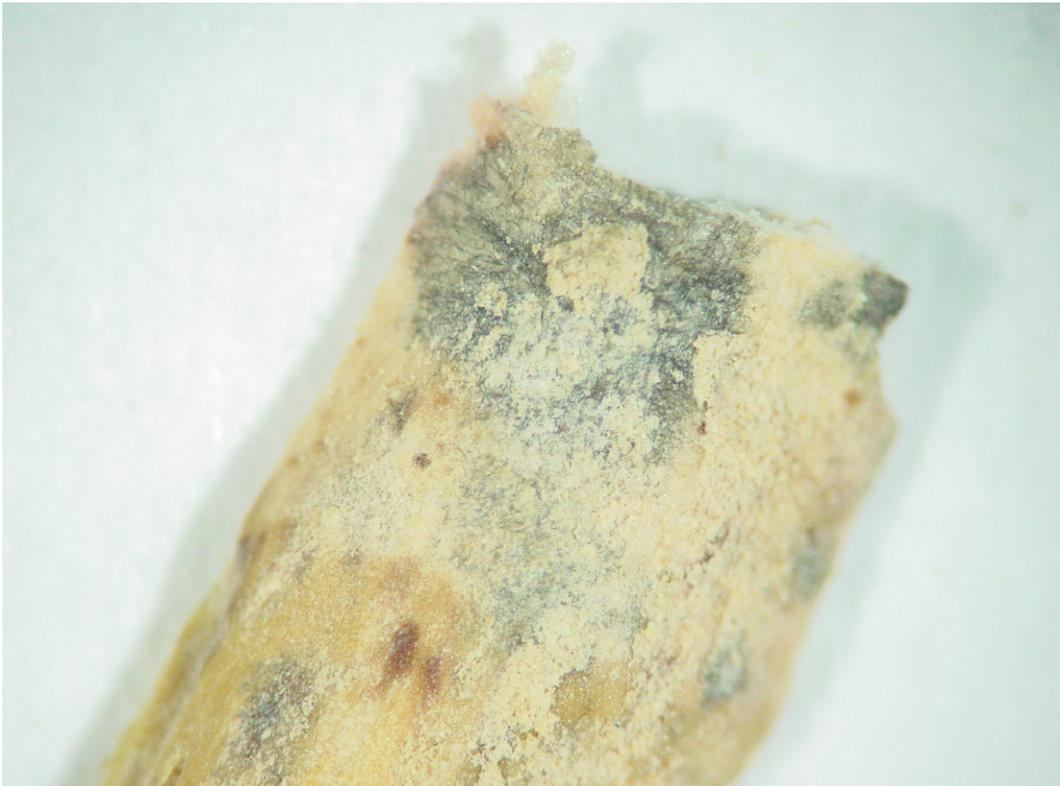
Bild 10-20: Pilz- und Lehmreste an Getreidehalm im Auflichtmikroskop (verputzter Prüfkörper)
