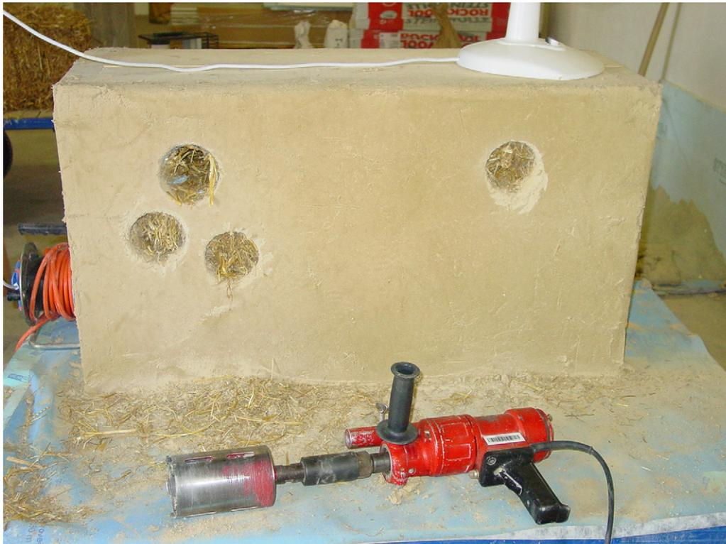
Bild 10-14: Probennahme aus dem verputzten Prüfkörper
