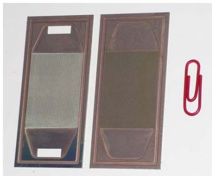
Abbildung 18 Ein Paar mikrostrukturierter Platten mit Schlitzen zur Gasführung, 44 Mikrokanäle mit 400 \mu\text{m} Breite, 250 \mu\text{m} Tiefe und 36 mm Länge, Konstruktion IMM
