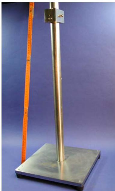
Abbildung 17 Aufbau für Falltests an Katalysatorbeschichtungen
