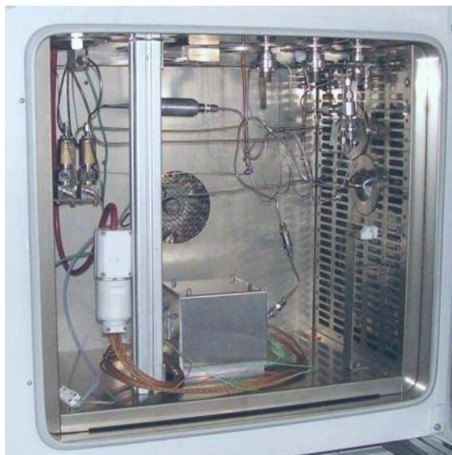
Abbildung 6 Elektrisch beheizter Ofen zur Aufnahme eines Festbettreaktors (Konstruktion LIKAT).
