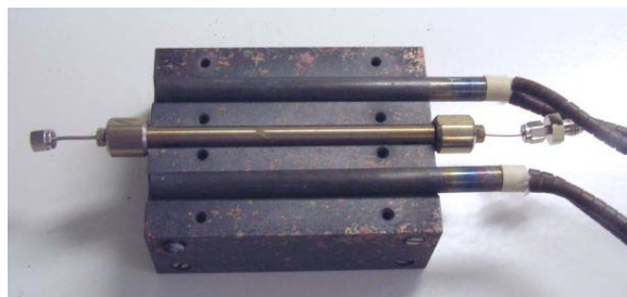
Abbildung 6 Elektrisch beheizter Ofen zur Aufnahme eines Festbettreaktors (Konstruktion LIKAT).
