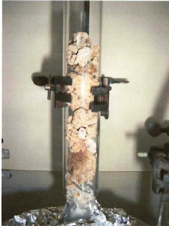
**Bild 3: Polymerisat nach 10min pumpen der Lösung:**
