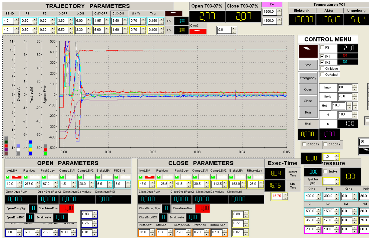
Abbildung 25: Aktuator-Bedienoberfläche mit integriertem adaptiven Regelalgorithmus
