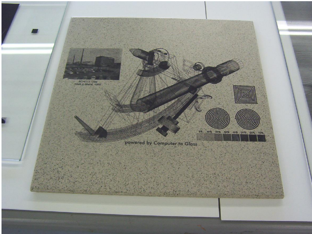
Abbildung 7: Mit keramischem Toner bedruckte Fliese
