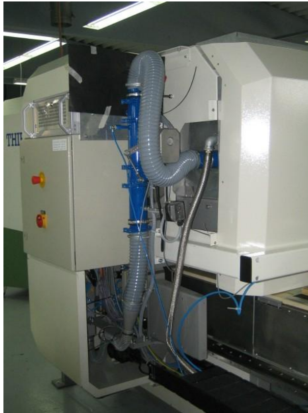
Abbildung 11: Energiezuführung der integrierten Heizung am Druckkopf
