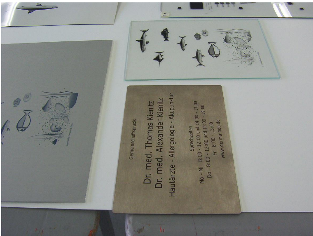
Abbildung 6: Duroplastischer Toner auf Glas , Blech und VA-Material
