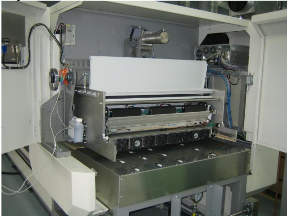
Abbildung 14: Druckkopf mit Entwicklerstation und Reinigungseinheit
