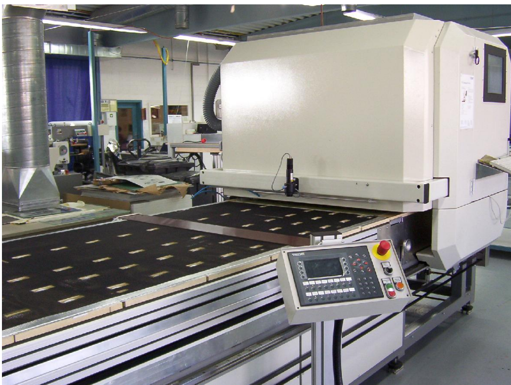
Abbildung 4: Ansicht der Verfahrenseinheit mit integrierter Heizung und Druckkopf
