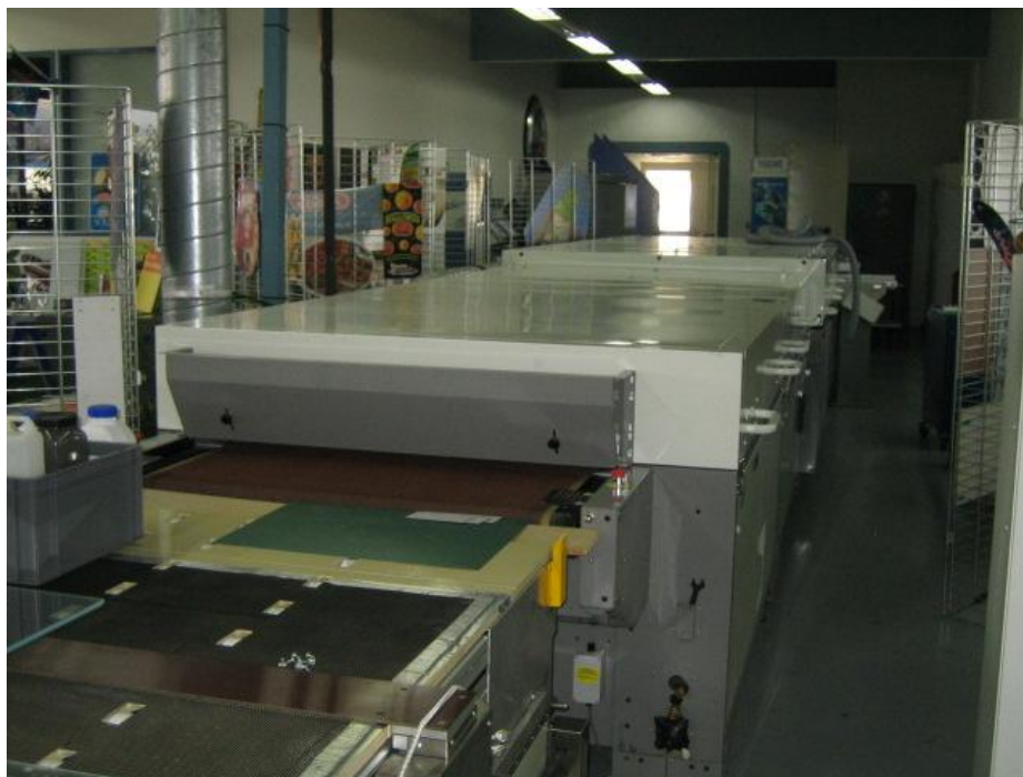
Abbildung 13: separater Durchlaufofen zum Vorheizen der Glasplatten
