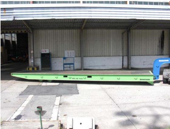
In der Konzeption zum Seetransport der 658 Betonelemente wird auf die im Fährhafen Sassnitz zur Verfügung stehenden, einheitlichen 40'RoRo-Trailer<sup>41</sup> (Länge: 12,0 m; Breite: 2,50 m) zurückgegriffen. Je nach Ausführungsart ist eine Zuladung bis zu 60 t bzw. 95 t möglich.
