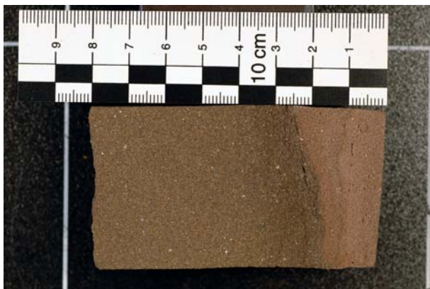
Bild 9-4: Profilschnitt des Bohrkerns BK3 aus dem 6. Pfeiler von Süden auf der Ostseite der Arkaden
