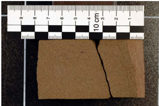
Bild 9-2: Profilschnitt des Bohrkerns BK1 von der Westseite des Pfeilers Nr. 6
