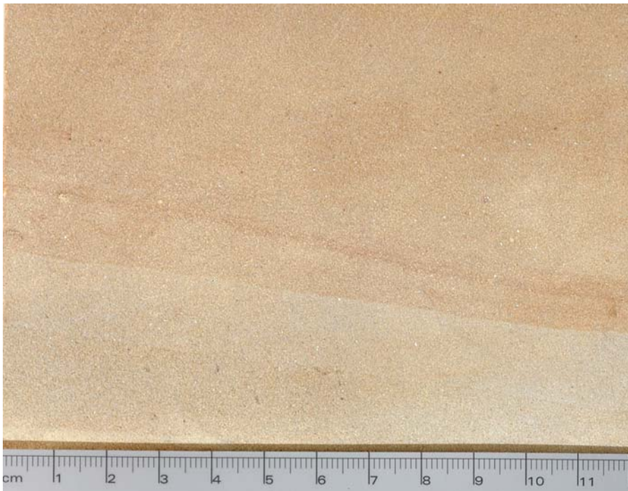
Bild 3-1: Musterplatte des an den Arkaden verbauten Rätsandsteins
