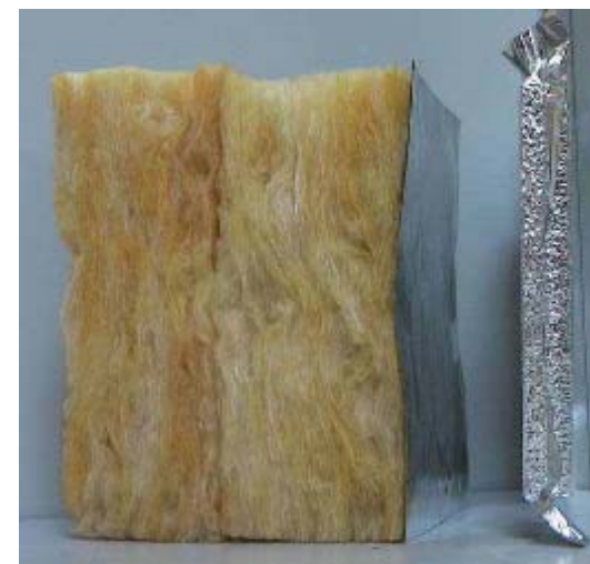
Abbildung 171 Faserdämmstoff / VIP (Quelle: www.bine.de )
