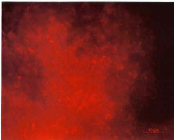
Abbildung 23: Ammonium - Oxidierer der behandelten Biofilmprobe (Nitri-Vit Test)
