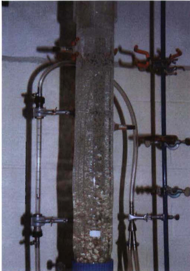
Abbildung 5: Aufwirbelungsversuch Flügelrad (300 l/h)
