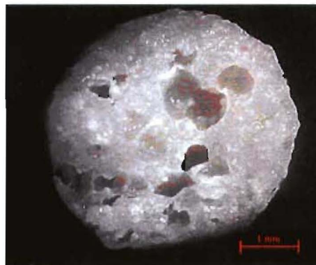
Abbildung 6: Schnittfläche geschäumtes Biocompound PHBCAPA 3070 G
