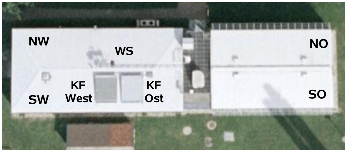
Abbildung 3: Dach des ZAE-Gebäudes. SW-Dachfläche mit den QuickStep SolarThermie Kollektorfeldern KF West (schiefergrau, dunkel) und KF Ost (blaugrau, hell); NW-Dachfläche mit Wetterstation (WS); SO- und NO-Dachflächen des hydraulisch offenen Kühlsystems (Quelle: Google Earth).
