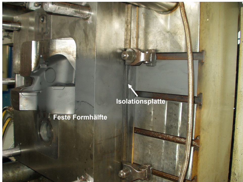
Abbildung 28: Versuchsaufbau für den Praxistest (mit Isolation)
