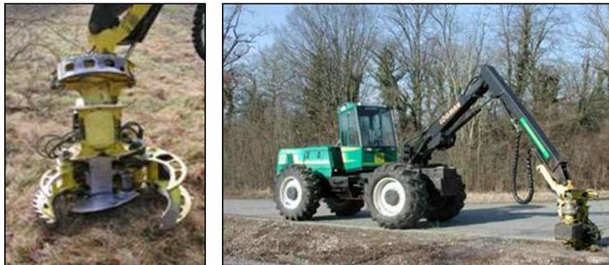
Abbildung 38: Fäller-Sammler-Aggregat Plustech 730, montiert an einen Harvester
