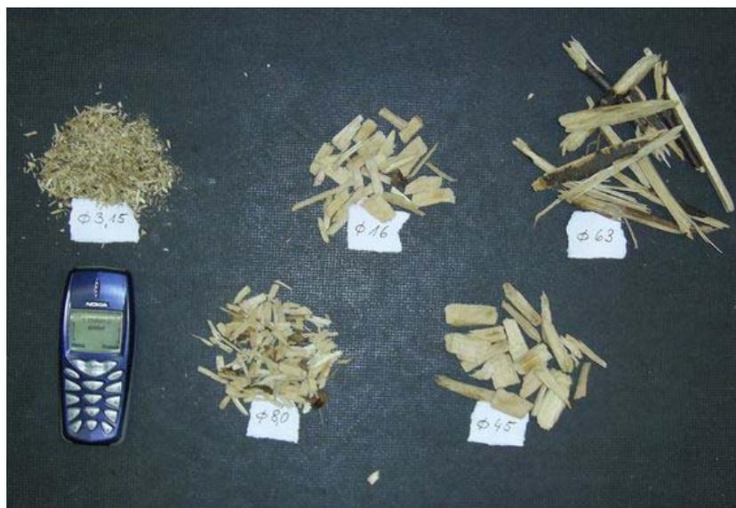
Abbildung 12: Unterschiedliche Hackschnitzel-Größenklassen nach dem Sortieren (ZAHN, 2006)
