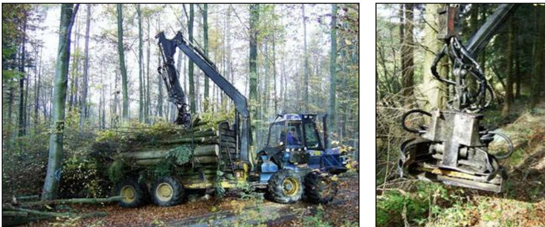
Abbildung 45: Forwarder (Rottne SMV Rapid) mit Fällgreifer (Hultdins) beim Rücken von Hackmaterial und Fällgreifer der Firma Hultdins
