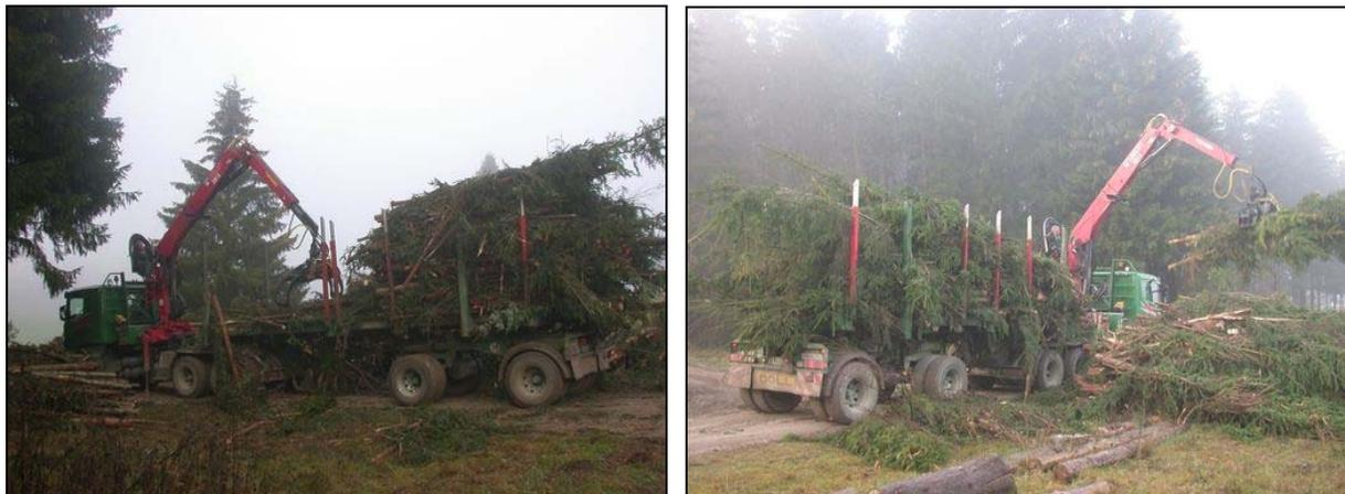
Abbildung 72: Beladung des LKW mit abgelängten Kronen (links) und langen, nicht eingekürzten Kronen (rechts)
