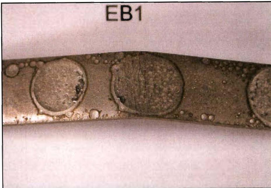
Abb. 28: Auf Zug beanspruchte Schicht im Biegeversuch; 30° Biegewinkel
