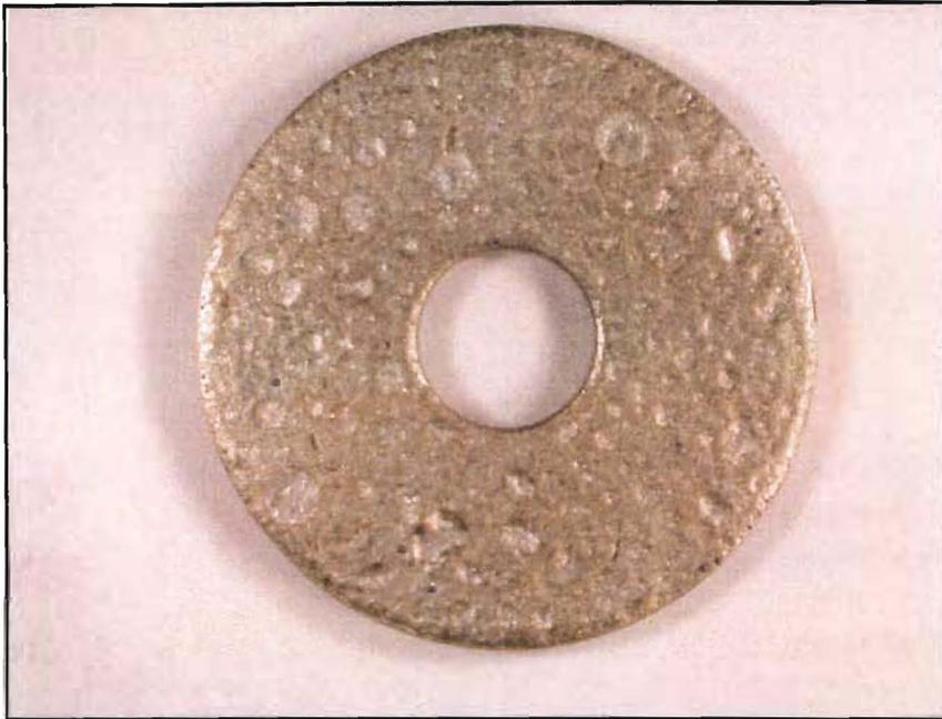
**Abb. 26: Beschichtete Scheibe aus dem Grundwerkstoff 1.2379**
