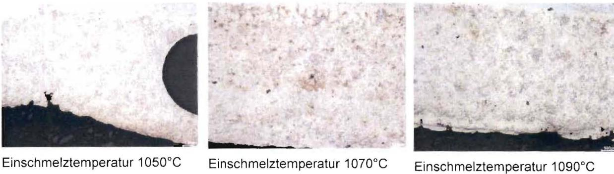
**Abb. 21: Ausbildung der Gefüge für unterschiedliche Einschmelztemperaturen bei 30% Emaille-Anteil**
