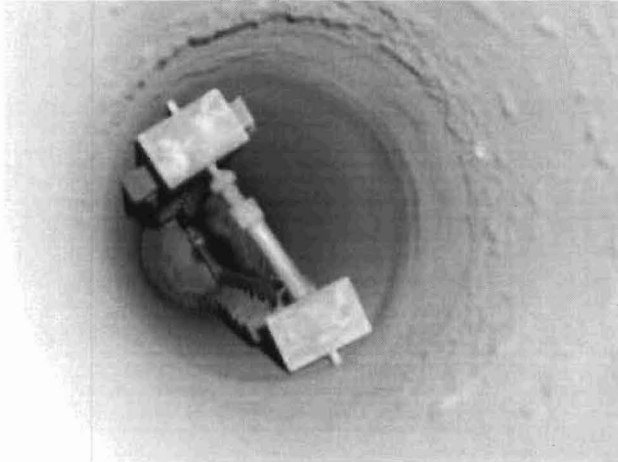
Abb. 9.7: Innenansicht des Drehrohrreaktor-Arbeitsrohres mit Hubschaufeln beim kalten Ofen und im laufenden Betrieb
