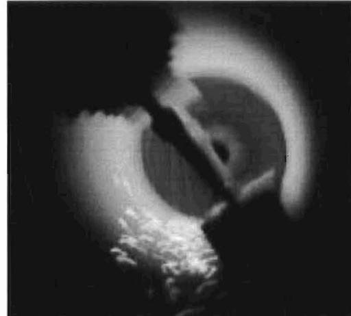
Abb. 9.7: Innenansicht des Drehrohrreaktor-Arbeitsrohres mit Hubschaufeln beim kalten Ofen und im laufenden Betrieb
